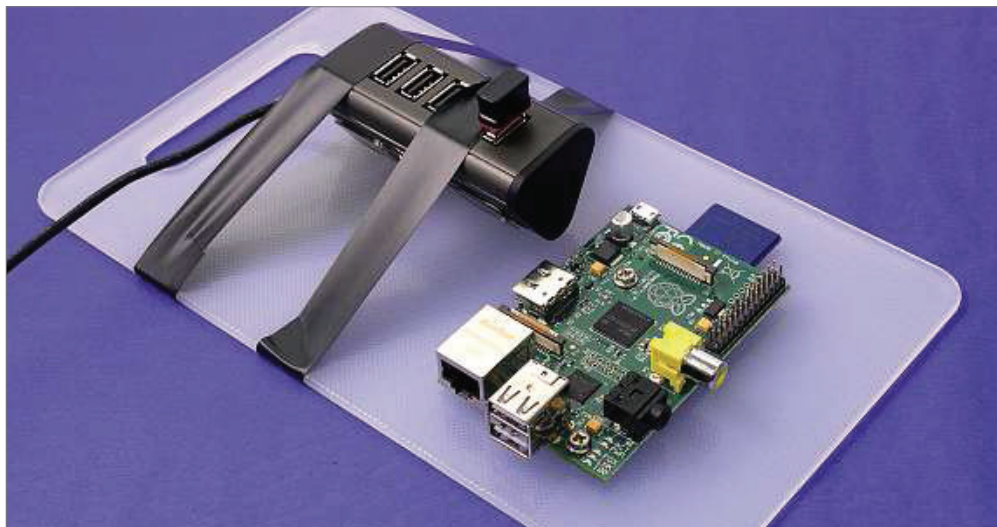
Bereit: Das aufmontierte Raspberry Pi mit SD-Karte und USB-Hub kann nun in einer unauffälligen Box unterschlüpfen
