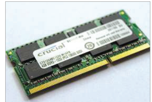
Nicht vorgesehen: Eine Speicher-Erweiterung per RAM-Riegel (hier ein DD3 Laptop-RAM) ist nicht möglich
