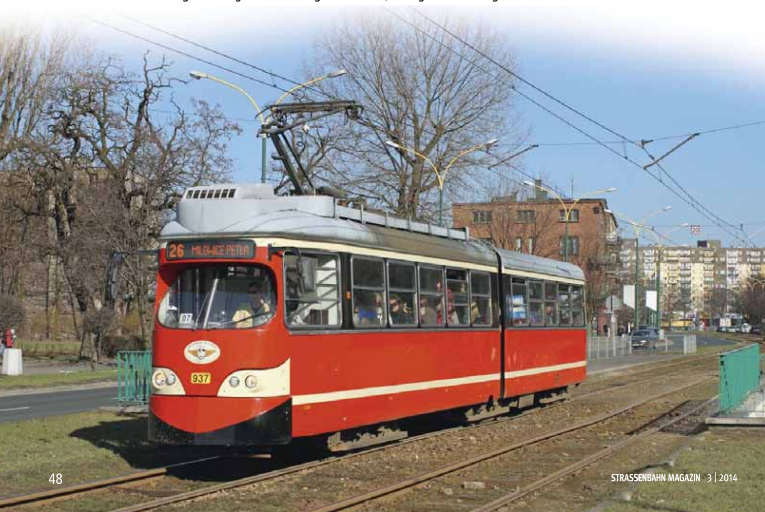
Kattowitz: Der E 1 937 ist im Depot Bedzin stationiert und kommt auf der Linie 26 zum Einsatz, hier am 15. April 2013 in Sosnowiec, ulica Marszałka Józefa Piłsudskiego. Auffällig sind das Klimagerät am Dach, die digitale Zielanzeige und die neuen Scheinwerfer
