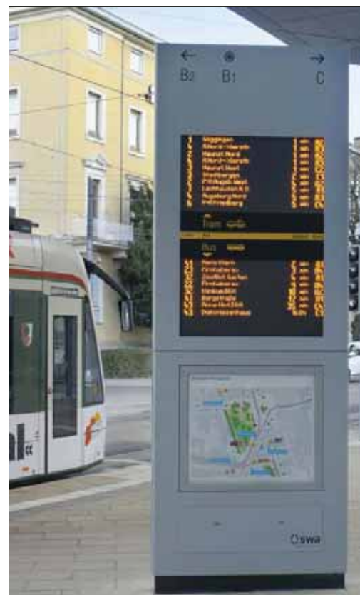
Zeitgemäße Übersichtsanzeigen informieren an den inneren Bahnsteigecken
