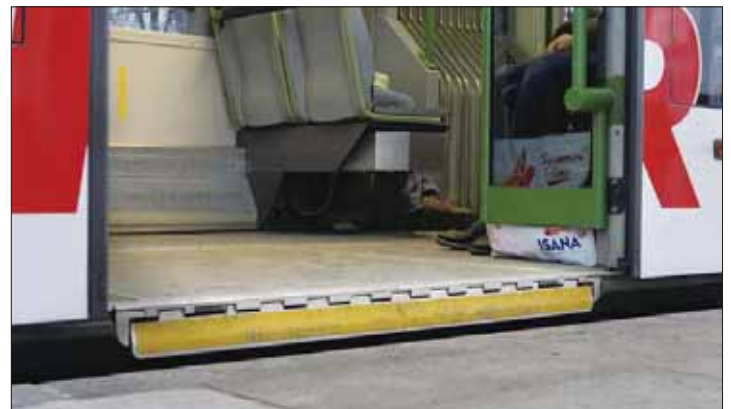
Kritikpunkt: Die Fahrzeugrampen der Straßenbahnen lassen sich an den Bahnsteigen unter ungünstigen Bedingungen nicht ausfahren
