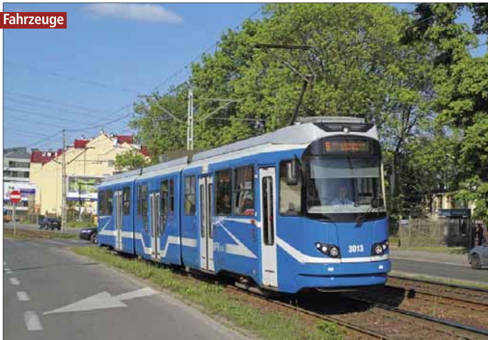
Krakau: Dem hier am 18. Mai 2012 fotografierten EU8N 3013 sieht man seine Herkunft nicht an. Er entstand 2010 aus je einem E 6 und c 6 . Das eingefügte Niederflur-Mittelteil wurde fabrikneu beim Unternehmen Autosan SA in Sanok beschafft
