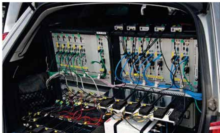
Rechts: Die Messausrüstung eines der beiden Fahrzeuge, zwischen denen die bewerteten Telefonie-Verbindungen laufen.
