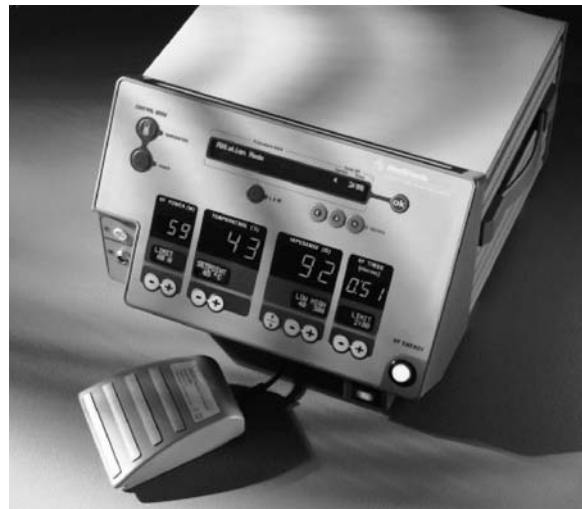
Abb. 2.5 RF-Generator Atakr II, Medtronic, mit Fußschalter. Betrieb im Temperatur- und Leistungsmodus (gekühlte Ablation, s. u.) möglich. Alle wesentlichen vorgewählten Parameter werden über das Display angezeigt, ebenso die Parameter während der Ablation: Dauer, Anzahl der Abgaben, Impedanz, Temperatur und Leistung.
