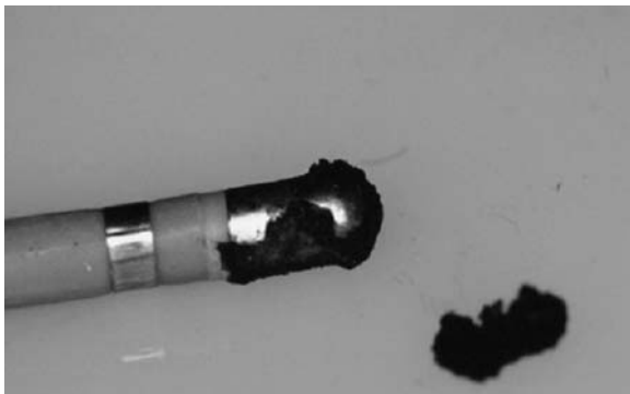
Abb. 2.6 Ausgedehnte Karbonisierung eines Ablationskatheters (4 mm Elektrode, Platin/Iridium). Daneben ein abgestreiftes Fragment der Elektroden-Karbonisation. Einzelheiten im Text.
