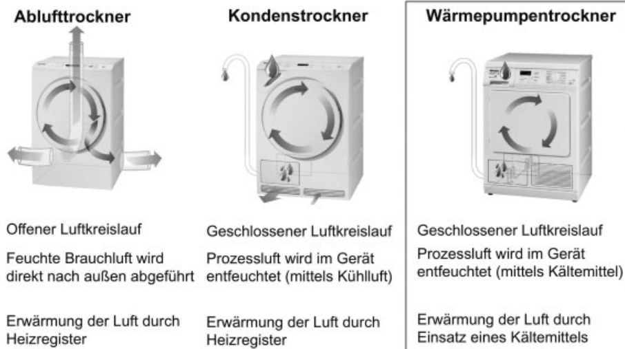
Abb. 1.27 Funktionaler Aufbau von Wäschetrocknern (Quelle: Miele).
