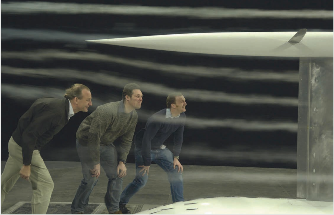
Im Windkanal wird eine Variante der sogenannten Kielbombe getestet. Das Modell ist im Maßstab 1:2 aus Kunstharz gefertigt (2005).
