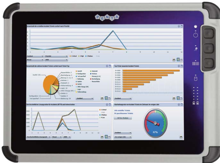
Das Multitouch-Display des PENTA Ultra-10 ist reflexionsarm und dank integriertem Lichtsensor auch bei einer Helligkeit von 800 bis 1000 cd/m 2 ablesbar
