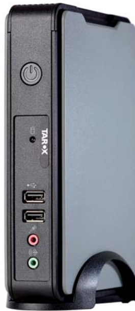
Nutzer des TC100R können den Thin Client entweder mit einer VESA-Halterung an der Monitorrückseite montieren oder auf dem Schreibtisch platzieren
