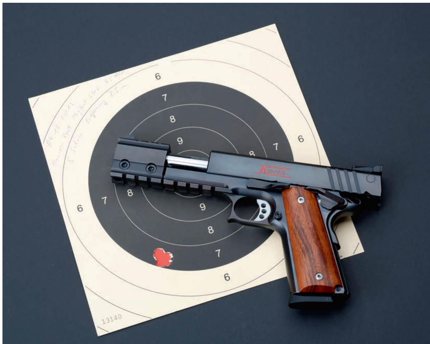
Das 5-Schuss Anschuss-Bild aus der Ransom-Rest-Schießmaschine des Herstellers ist vielversprechend.
