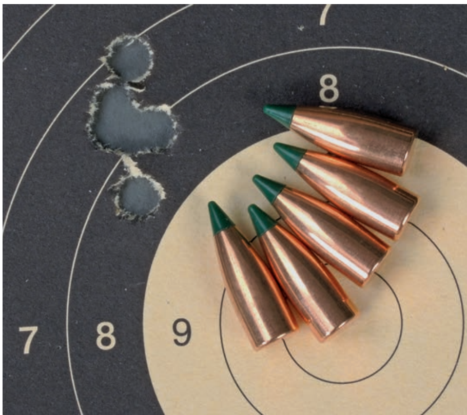
Topstreukreis des Schmeisser AR-15 Target mit Handlaborierungen mit leichtem 40 Grains Sierra BlitzKing Geschoss.
