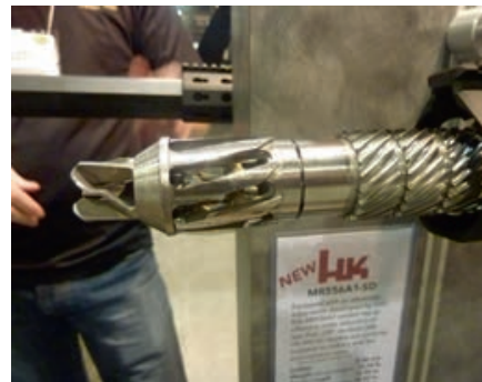
Neue HK 556A1 Schalldämpfer-Version und Blick auf das Innenleben des aufwendigen OSS Schalldämpfers bei abgenommenem Mantel.
