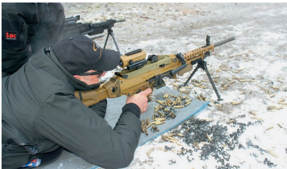
Bei dem HK 121 alias MG 5 in 7,62x51 kann die Feuerkadenz von 640 auf 720 oder 800 Schuss pro Minute verstellt werden.
