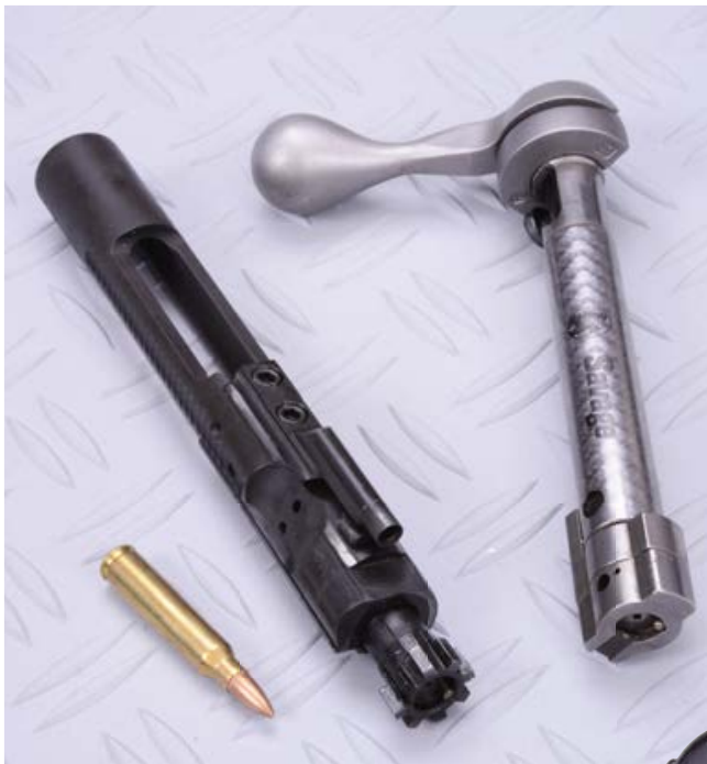
Systemvergleich: Die Verschlusskammern mit ihren Verriegelungsköpfen. Links das halbautomatische DAR-15-System, rechts das manuell zu bedienende Savage M12-System.
