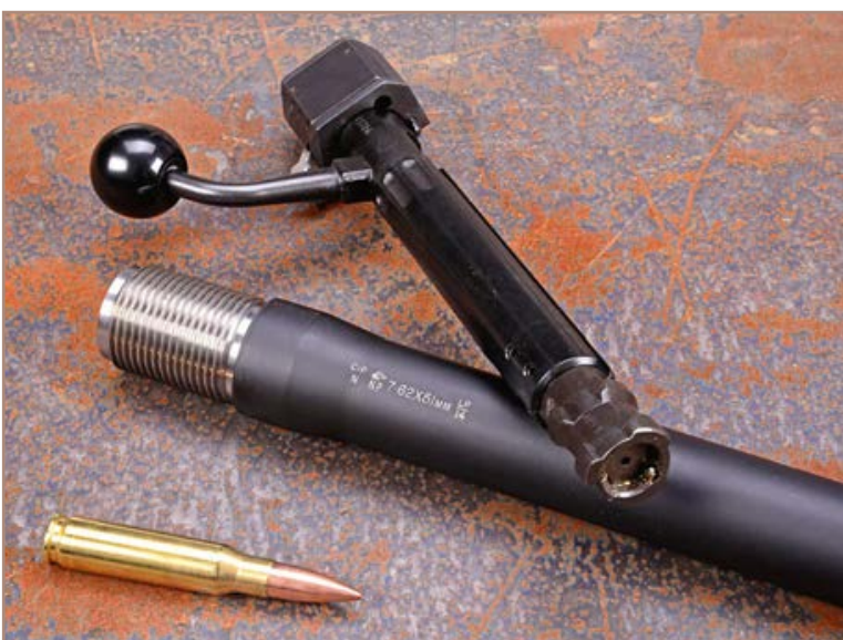
Der Kopf der Verschlusskammer verriegelt mit sechs Verriegelungswarzen auf zwei Ebenen in der Systemhülse.
