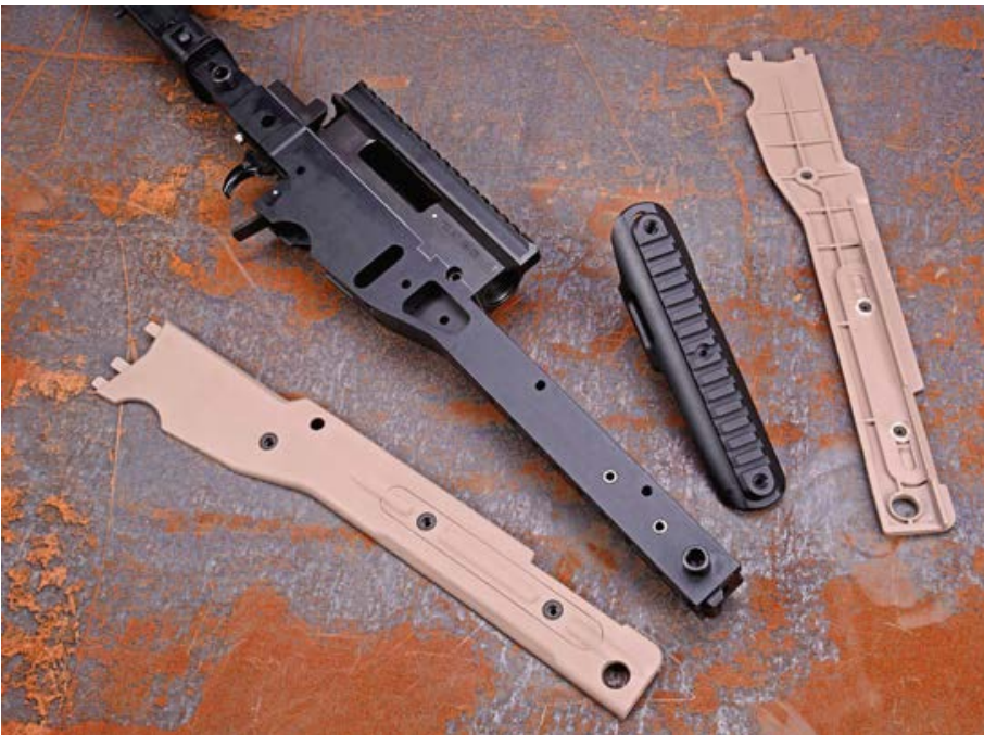
Die Zweibein-Aufnahme sowie die komplett demontierte Vorderschaftpartie des AT308.
