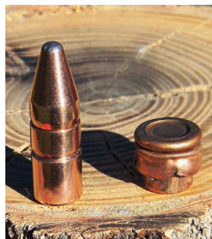
Überbleibsel aus Deutschland: Der hintere Kern des 181 Grains RWS Doppelkerngeschosses wies nach der Bergung rund 106 Grains Restgewicht auf.
