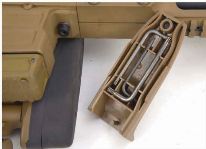
Bordwerkzeug: Die Tools im unscheinbaren Werkzeugfach und der spezielle Kammerstängel reichen aus, um einen kompletten Kaliberwechsel durchzuführen.
