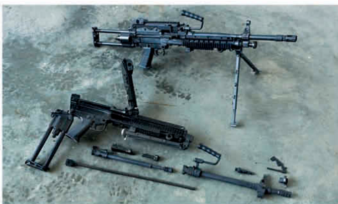
Zusätzlich aus der Gasentnahmeeinheit des Laufes ausgebauter Kolben und Verstellmechanismus (mit Spezialwerkzeug, mittig über dem Korn liegend).
