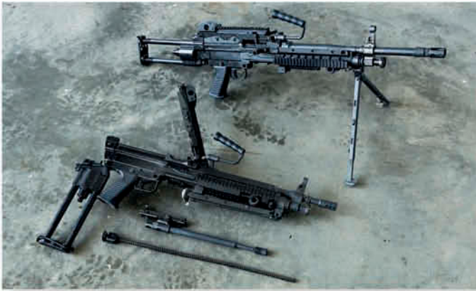
Entnahme der Verschluss- und Gasrohrereinheit mit "Long Stroke" Gaskolbensystem.
