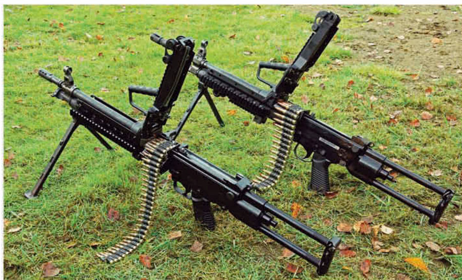
Zwei Minimi mit aufgeklappten Gehäusedeckeln und eingelegten Gurten. Blick auf die vom FN MAG abstammende Zuführmechanik für den Patronengurt. Der Gurt wird dabei in zwei Stufen in die Vorwärts- und Rückwärtsbewegung des Verschlussträgers gefördert, was einen störungsarmen Munitionstransport gewährleistet.
