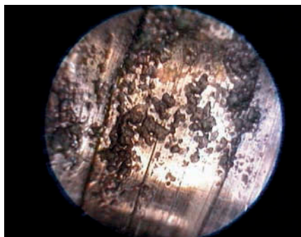
Hier Aufnahmen aus dem Laufinneren, die einmal das berühmt-berüchtigte "pitting" (Rostpfützenbildung) und einmal, trotz intensiven Putzens, die immer noch vorhandenen Kupferablagerungen zeigen.
