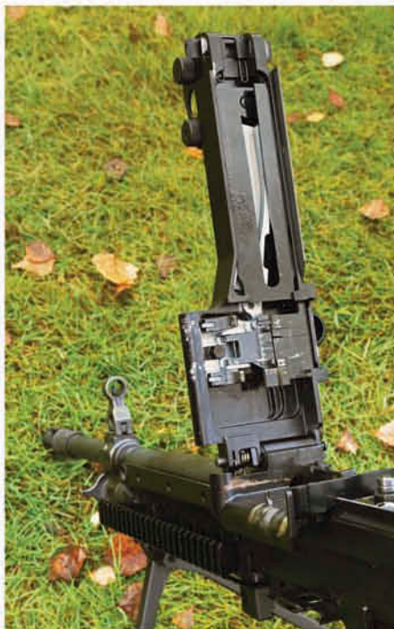
Zwei Minimi mit aufgeklappten Gehäusedeckeln und eingelegten Gurten. Blick auf die vom FN MAG abstammende Zuführmechanik für den Patronengurt. Der Gurt wird dabei in zwei Stufen in die Vorwärts- und Rückwärtsbewegung des Verschlussträgers gefördert, was einen störungsarmen Munitionstransport gewährleistet.
