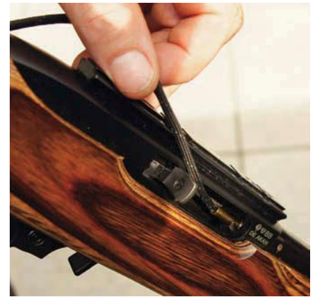
Flexible Reinigungsschnüre à la "QuickClean" und "BoreSnake" eignen sich vor allem für die schnelle Zwischenreinigung unterwegs.
