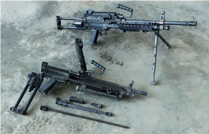
Vom Gasrohr getrennter Verschlussträger und Drehkopfverschluss.
