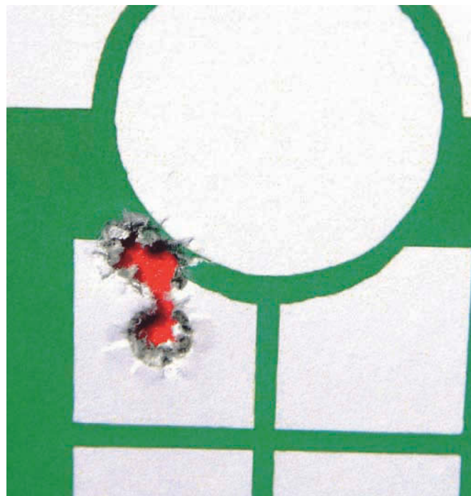
Bestschussbild: Die 8x68S Laborierung mit 73,1 Grains Hodgdon H4831SC und 200 Grains Nosler Partition brachte unter Mitwirkung des Schützen diese ansehnliche 14-Millimeter-Gruppe zustande.
