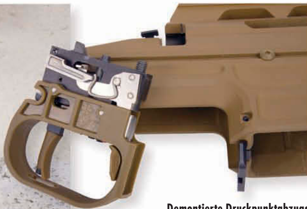
Demontierte Druckpunktabzugseinheit mit im Abzugsbügel untergebrachtem, ergonomischem Sicherungshebel.
