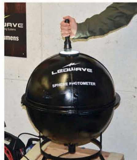
Mit dieser Ulbricht-Kugel und modernster Messtechnik konnte Taschenlampen wirklich auf den Zahn gefühlt werden. Normalerweise wird die Lichteingangsöffnung mit passgenauen Deckeln verschlossen, was hier aus Anschauungsgründen nicht gemacht wurde.
