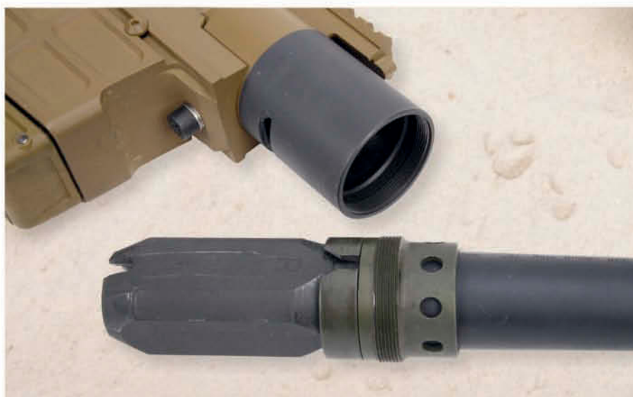
Demontage des Laufes mit Spezialschüssel und die Verbindung zwischen Systemkasten und Lauf im Detail.
