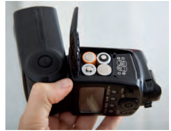
Der Canon-Blitz Speedlite 580EX II wird über vier Batterien mit Strom versorgt.
