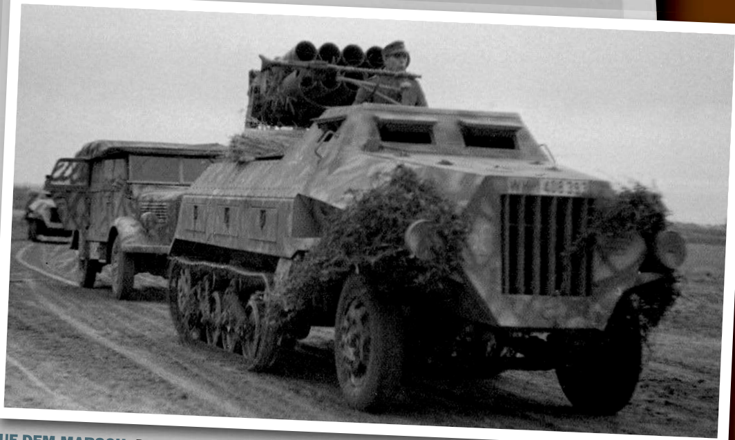
AUF DEM MARSCH: Der Panzerwerfer 42 ist leicht mit Buschwerk getarnt. Das Bord-MG 34 ist lafettiert, vermutlich werden feindliche Flieger erwartet. Foto: Sammlung Anderson
