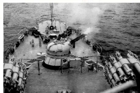
BEEINDRUCKEND: Eine Salve aus der AK-230. Die Zwillingswaffe mit Kaliber 30 mm ist vollautomatisch.
