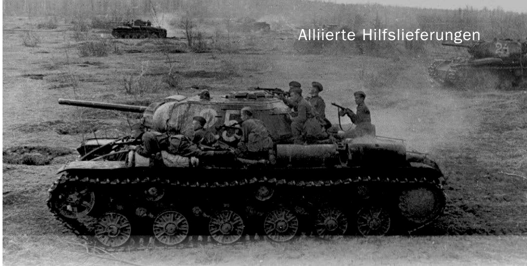
NICHT AUSGEREIFT: Der KW 1 wurde als schwerer Panzer konzipiert, zeigte aber keine bessere Bewaffnung als der deutlich leichtere T 34. Hier fahren KW 1s zum Angriff, der neue Stahlgussturm mit der 7,62-cm-Kanone ist gut zu erkennen.
