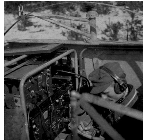
DETAIL: Das Innere des Sd.Kfz. 250/5. Der Soldat sitzt vor dem Funkgerätesatz 8, bestehend aus dem Mw. Empfänger c (oben) und dem 30 W Sender a (unten).
