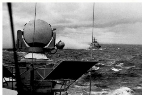
TARNUNG AUF SEE: Die Anlage zum Erzeugen von Nebel ist bei dem Schiff im Hintergrund in Betrieb.
