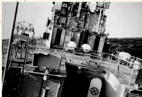
MARINETECHNIK: Links im Bild ein Fasta-4-Starter ohne Raketenbehälter. Dahinter an den Aufbauten ein PK-16 Düppelwerfer.
