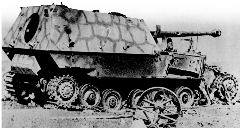
VERNICHTET: Ein während der Kämpfe bei Kursk zerstörter deutscher Jagdpanzer „Ferdinand“ mit 8,8-cm-Pak auf Selbstfahrlafette. Vor allem auf große Entfernung konnte dieser Panzer dem Gegner schwere Verluste zufügen, doch für die Infanterienahbekämpfung fehlte ihm ein eingebautes MG.
