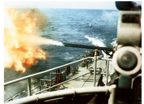
GESCHÜTZDONNER: Abschuss einer AK 725 (zwei Rohre Kaliber 57 mm, L/80). An Deck verzurrt eine WB-1.
