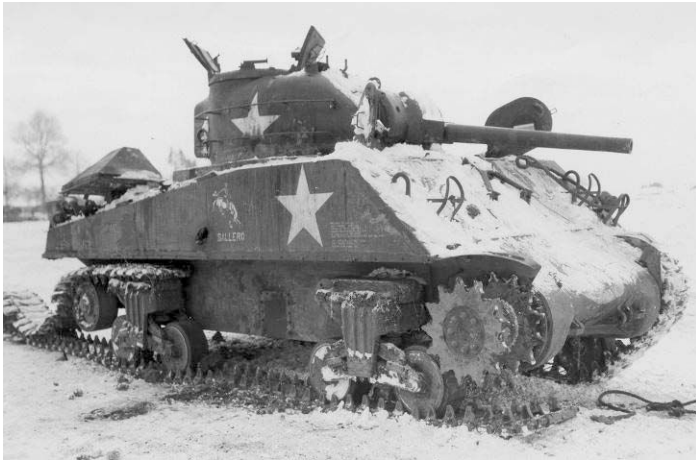
ZERSTÖRT: Dieser „Sherman“ zeigt mehrere Einschusslöcher an der Seite. Der mittlere Rollenwagen ist durch die Wucht einer Detonation abgerissen worden.
