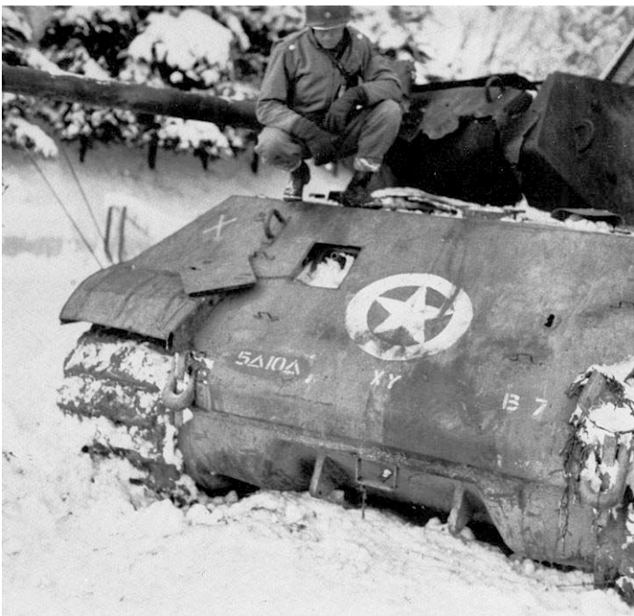
FÄLSCHUNG: Dieser US-Soldat kann es kaum fassen. Täuschend ähnlich einem amerikanischen M/10 nachempfunden, fand dieser „Panther“ sein Ende. Selbst kleinste Details wie Abschleppösen oder die typischen Verkleidungen der Seitenvorlege wurden nachempfunden. Foto: Zaloga
