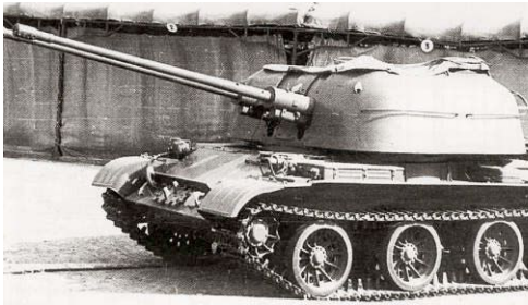
IMPOSANT: Lange Rohre und großer Turmaufsatz - Fla-SFL 57/2. Foto: Sammlung Dirk Krüger
