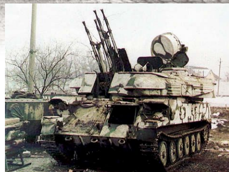
VIERLING: Vier mal AZP-23 Maschinenka- nonen. Effektive „Kugelspritze“ des Flakpan- zers SHILKA.
