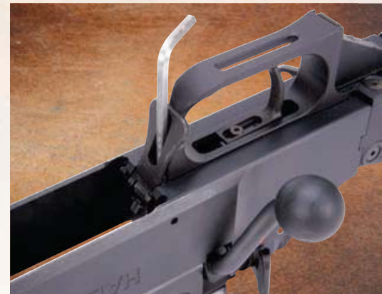
Versteckte Systemschraube auf der Leichtmetallträger-Unterseite im Bereich der Magazinauslösetaste.
