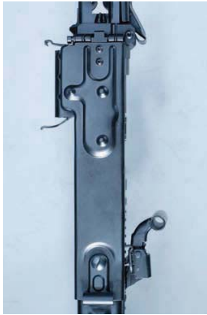
Systemkasten mit geschlossenem Gehäusedeckel und abgenommenem Trommelmagazin. Der Hebelspannschieber kann originalgetreu vor- und zurückbewegt werden.
