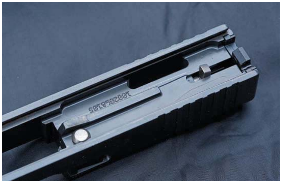
Zur Gewichtsreduktion des Verschlusses der G41 gehört auch die Ausfräsung dieser Tasche.
