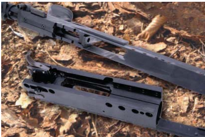
Der Systemkasten wird mit seiner U-förmigen Unterseite sauber im Leichtmetallchassis gebettet.
