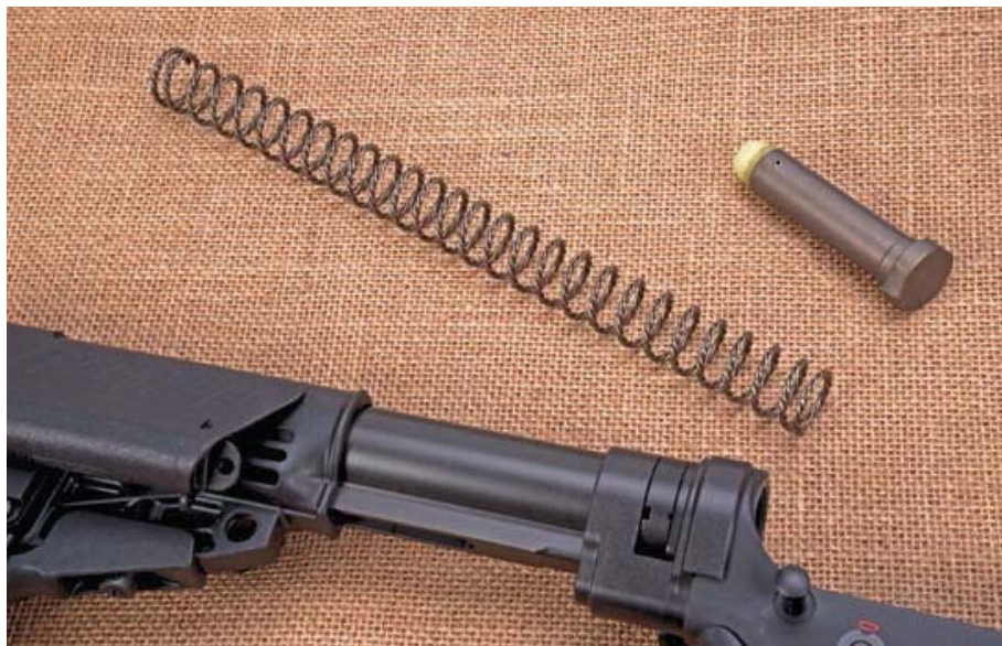
Spezieller Puffer samt Multidrahtfeder.
