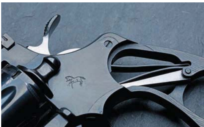
Die Zwei-Schenkel-Schlagfeder im Griffstück des Rahmens im entspannten und gespannten Zustand.
