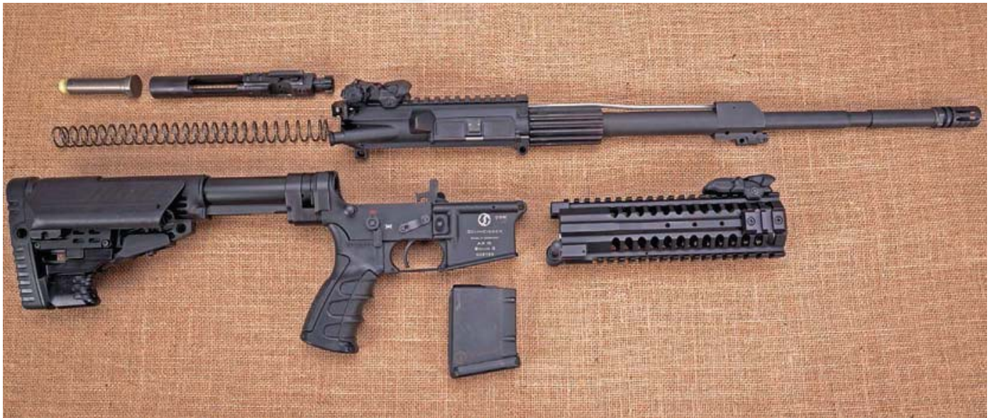
In Seitenansicht und in die Hauptbestandteile zerlegt.
