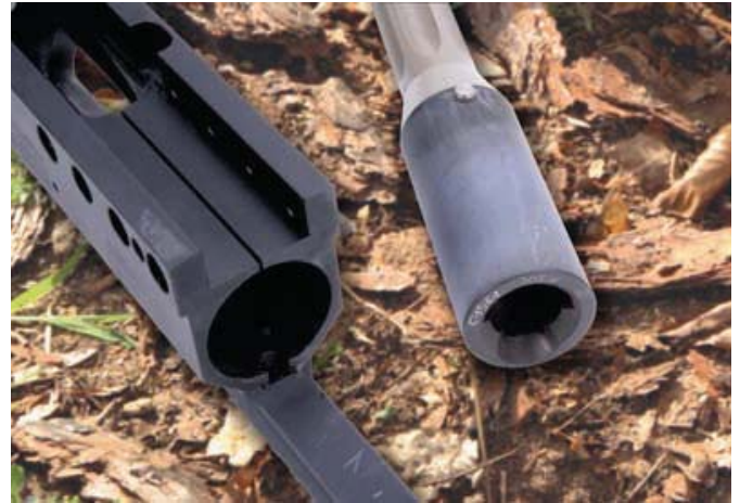
Der aus dem Leichtmetall-Systemkasten befreite Lauf.
