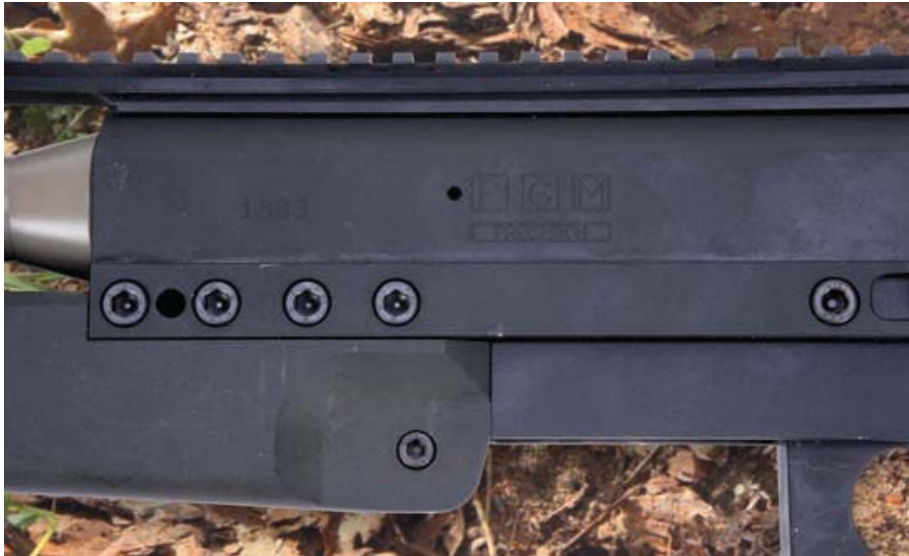
Gasentlastungsbohrung im und Hersteller-Markierungen auf dem Systemkasten.
