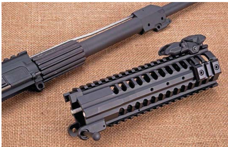
Der entfernte „Slim Line“-Handschutz gibt den Blick auf den Lauf mit langer Laufmutter und Gasrohr frei.
