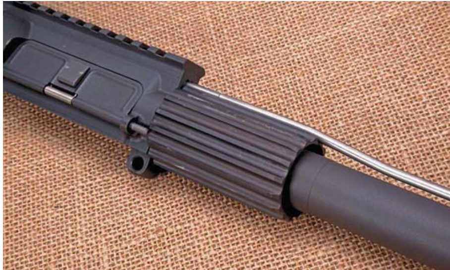
Lange Laufbefestigungsmutter („barrel nut“) mit viel Gegenlager-Fläche für die Kunststoffeinsätze des Handschutzes.
