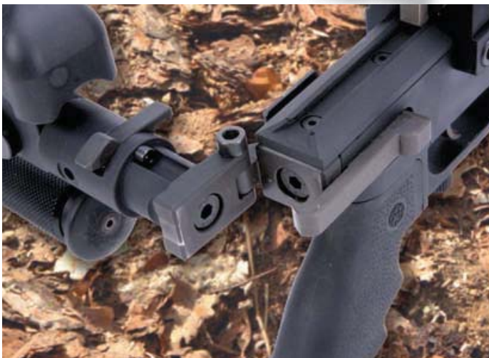
Aufwendige Mechaniken für das Gelenk der klappbaren Schulterstütze und für das Zweibein.
