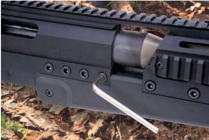
Es gibt viele Schrauben zu lösen, wenn man ein PGM Precision Ultima Ratio Gewehr in seine Einzelteile zerlegen möchte.
