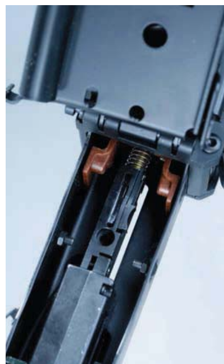
Blick in das Innere des Systemkastens bei geöffnetem Gehäusedeckel. In der Nahaufnahme erkennt man das „Hop-Up“-System, das den 6 mm Kunststoffkugeln mehr Flugstabilität verleiht. Es ist ideal eingestellt, wenn die „Baby Bullets“ möglichst weit und gerade fliegen.
