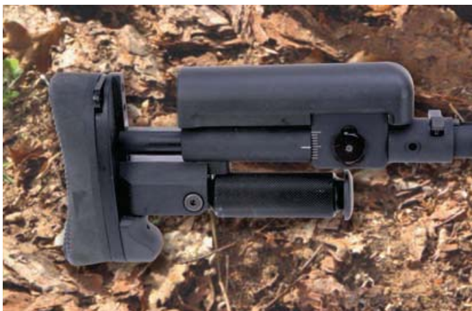
Hecksporn im eingeklappten und in zwei unterschiedlichen Positionen im ausgeklappten Zustand.
