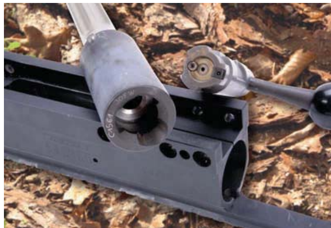
Der Verschluss verriegelt direkt im Laufgegenlager.
