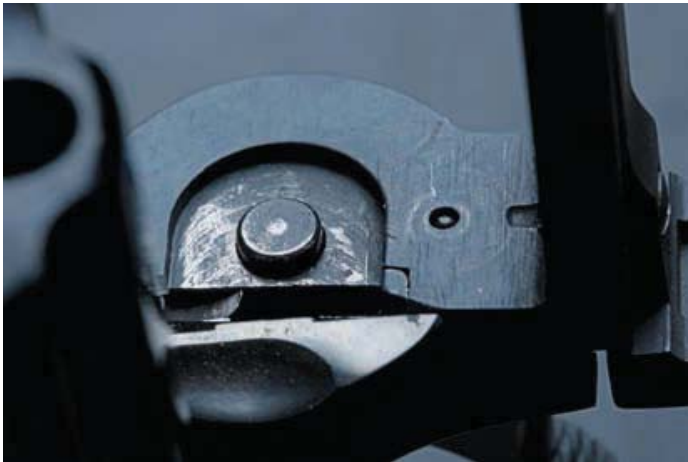
Blick auf die Trommelverriegelung mit dem auf der rechten Seite sitzenden Transporteur
