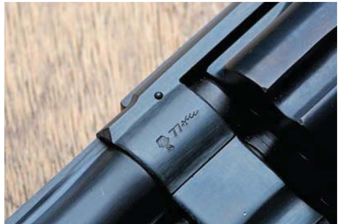
Der Lauf wurde, wie bei alten Smith & Wesson Modellen zusätzlich zu der Verschraubung noch verstiftet.
