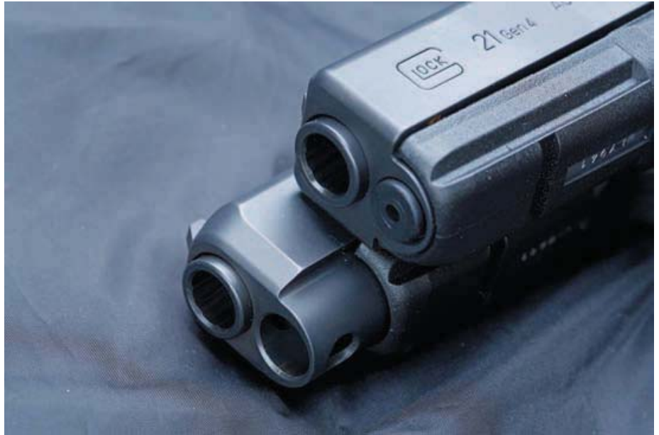
Die stark angefasste Mündungspartie der G41 mit der darunter hohl gebohrten Mündungsbrille für die Standard-Verschlussfeder.
