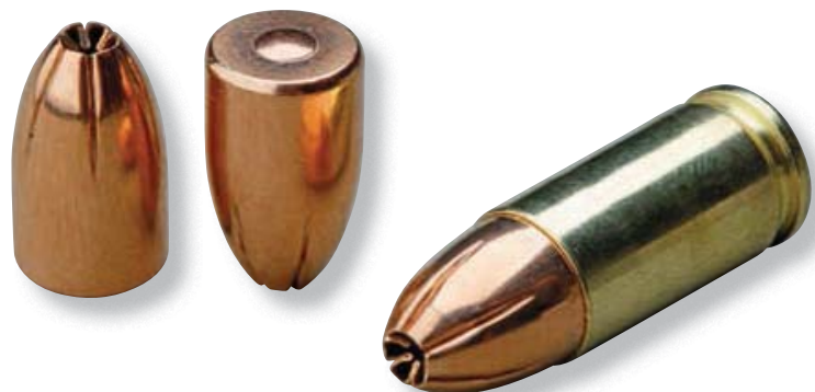
Der Name Hexagon, altgriechisch für Sechseck, stammt von den sechs Einkerbungen im Mantel, die an der Geschoss-Spitze enden. Die runde Erhebung auf dem Geschossboden ist ein typisches, durch die Fertigungstechnik bedingtes Markenzeichen der Hexagon Geschosse.
