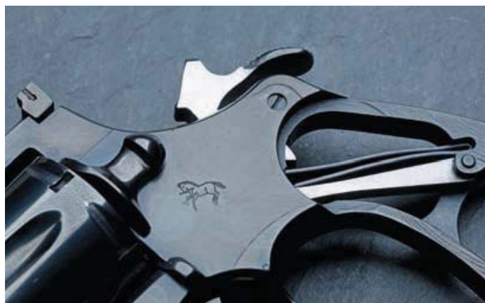
Die Zwei-Schenkel-Schlagfeder im Griffstück des Rahmens im entspannten und gespannten Zustand.
