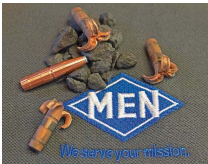
Die geborgenen Geschosse wiesen nahezu 100% Restgewicht auf und expandierten auf einen Durchmesser von rund 20 Millimeter.
