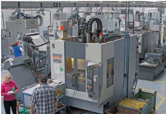
Moderne Maschinen im Meopta-Werk in Tschechien für das Fräsen der Rohrkörper aus dem Leichtmetall-Vollmaterial oder das Polieren der Linsen. Hier werden Absehen geätzt. Roboter kleben die Linsen.
