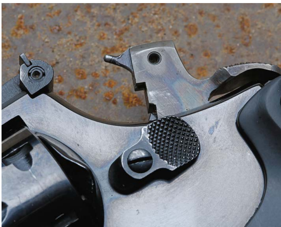
Damals saß bei S&W der Zündstift noch angelenkt im Hammer.
