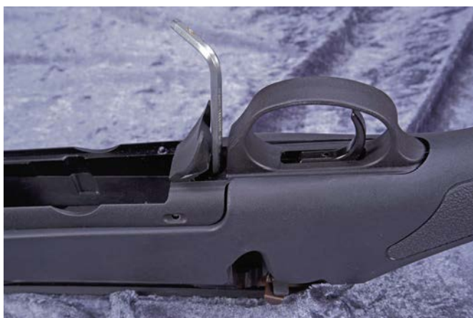
Versteckte Systemschraube unter der Magazinauslösetaste.
