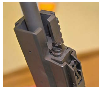
Blick auf die Gasentnahme-Einheit und die Impulsstange. Die Gasdüse lässt sich für Normal- und Schalldämpferbetrieb umstellen.
