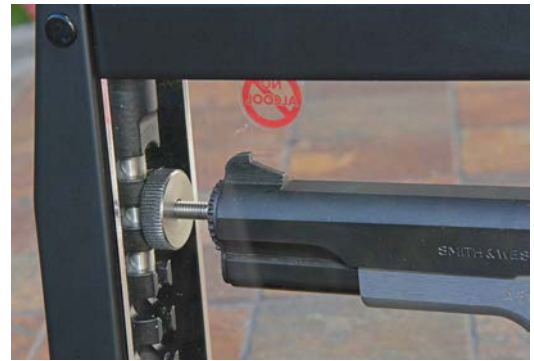
Beim Modell Universal wird die Waffe über einen Kaliberdorn mit Rändelschraube gehalten.
