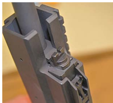
Blick auf die Gasentnahme-Einheit und die Impulsstange. Die Gasdüse lässt sich für Normal- und Schalldämpferbetrieb umstellen.
