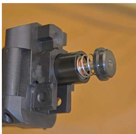
Der spezielle Öldruckpuffer in der Schulterstütze trägt wesentlich zum zahmen Schussverhalten des APC300 bei.
