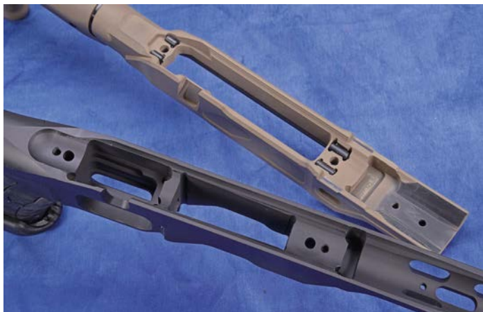
Die Remington 700 Systembettungen der beiden Leichtmetallschäfte im Vergleich. Oben Cadex Field Strike, unten MDT Light Striker System.
