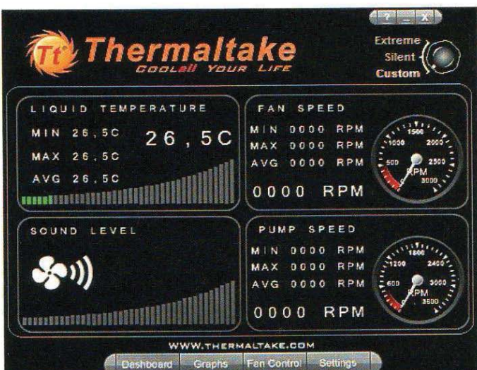
Auf einer DVD legt Thermaltake eine Software zur Lüftersteuerung bei. Neben der Geschwindigkeit von Pumpe und Lüfter zeigt sie die Temperatur des Wassers.
