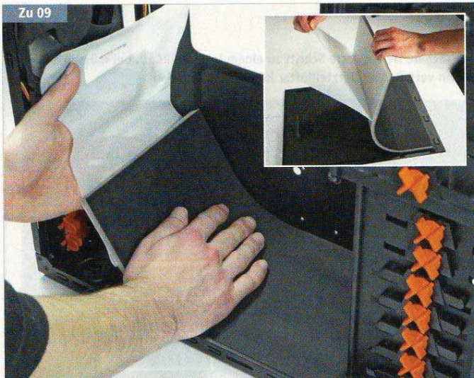
Dämmmatten zum Selbsteinkleben reduzieren Vibrationen des Gehäuses und absorbieren einen Teil der von den Komponenten des Systems erzeugten Geräusche.
