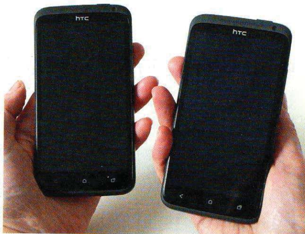
Von außen sind HTC One X und HTC One XL nahezu identisch. Während in Ersterem aber der Quadcore-Chip Tegra 3 arbeitet, nutzt das One XL das Dualcore-Modell Snapdragon S4.
