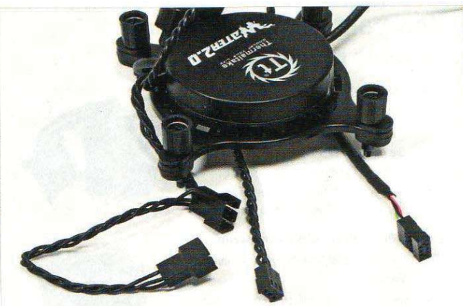
Die Water 2.0 Extreme gibt sich anschlussfreudig: Neben dem Pumpenanschluss hat sie Brückenstecker für die Lüfter und einen USB-Stecker für die Lüftersteuerung.
