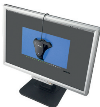
Abb. 11.3: Ein Gerät wie der Spyder von Datacolor (Abbildung) oder ColorMunki von X-Rite hilft, den Monitor zu kalibrieren. (Foto: Datacolor)
