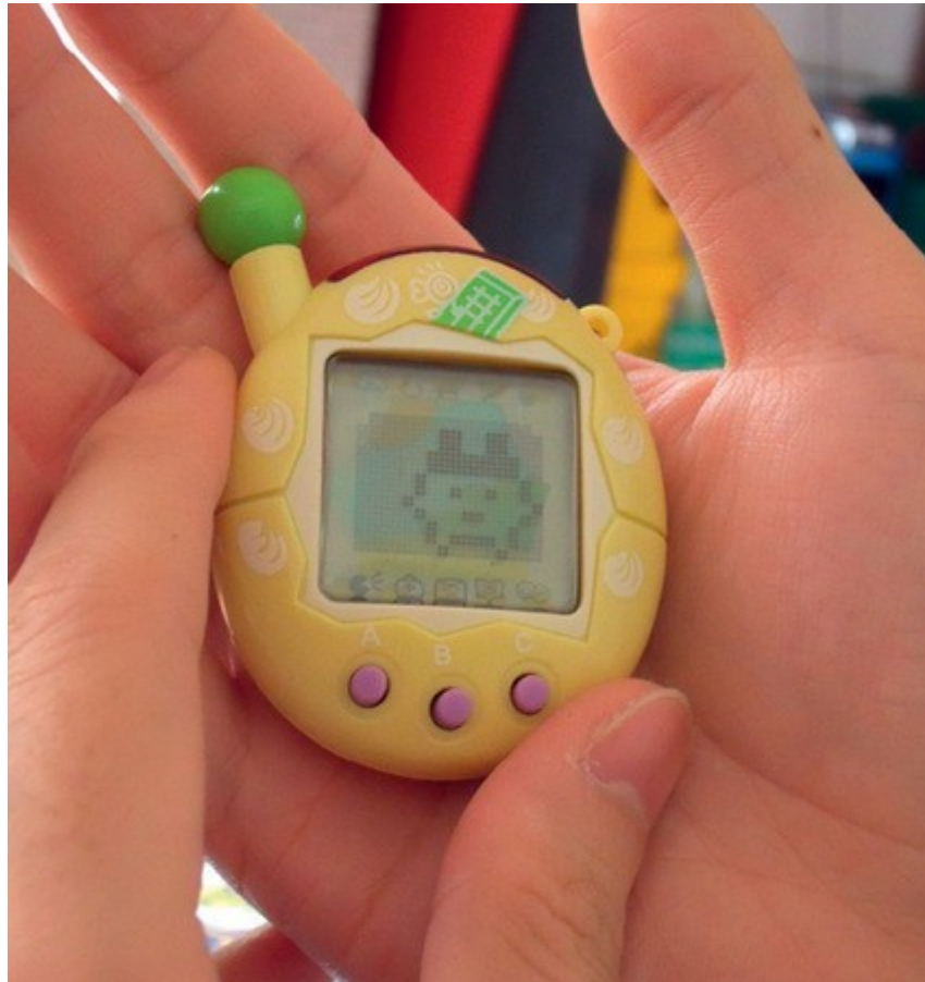
Das erste Tamagotchi hatte eine Bildauflösung von gerade mal 16 x 32 Pixeln.
