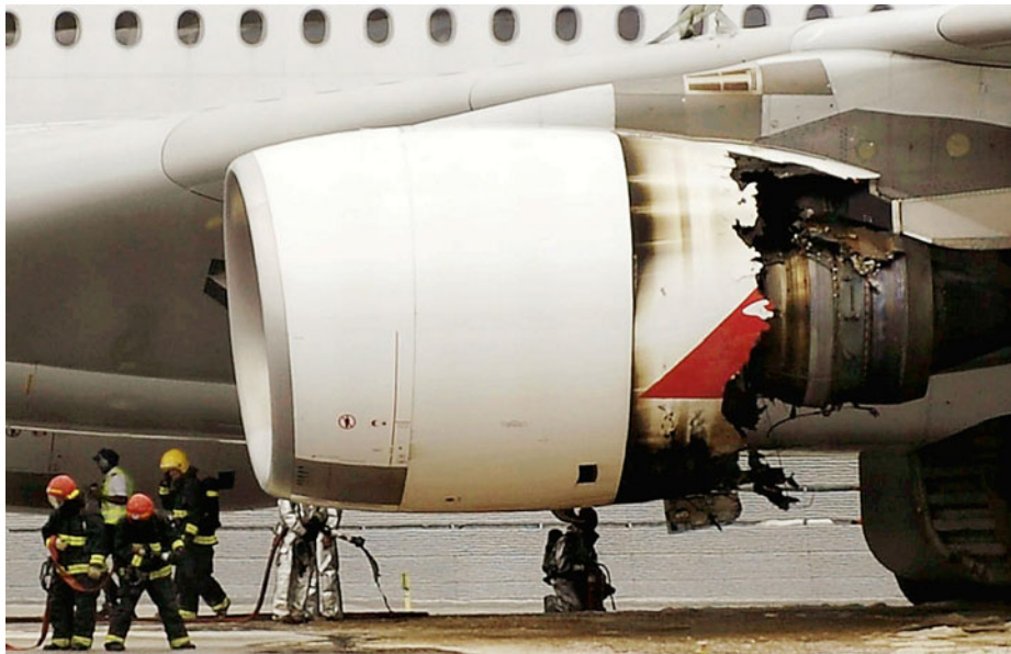
Qantas-A380 nach Triebwerksexplosion im November 2010: Streifspuren am Rumpf
