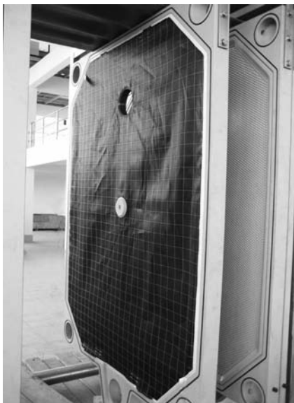
Abb. 4.46 Platte mit Filtertuch und Maischeumlaufkanal („Loop“)
