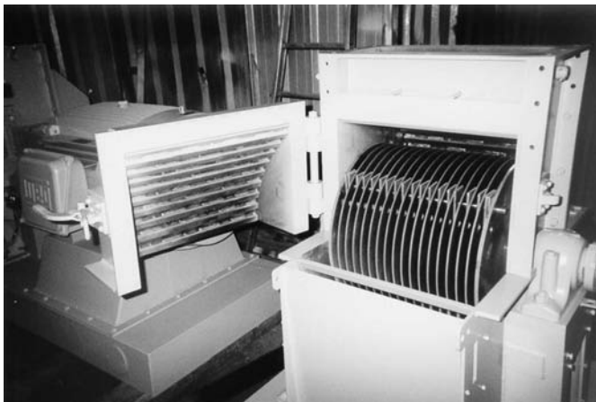
Abb. 2.18 Hammermühle mit horizontaler Rotorachse im aufgeklappten Zustand
