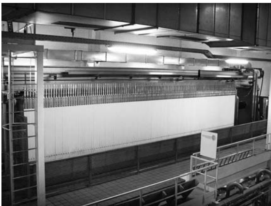
Abb. 4.45 Kammern/Platten, Filter insgesamt
