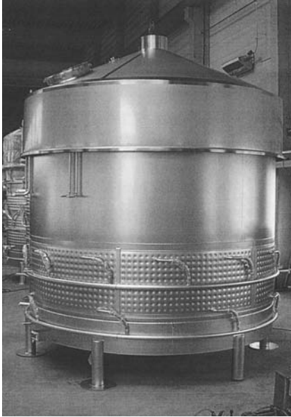
Abb. 3.27 Maischgefäß mit lasergeschweißten Heiztaschen
