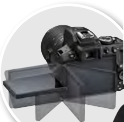
DAS DISPLAY DER D5300 LÄSST SICH VERTIKAL UND HORIZONTAL SCHWENKEN.
