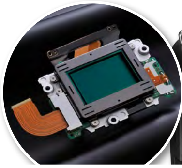
DER CMOS-SENSOR (35,9 X 24 MM) IM NIKON-FX-FORMAT LÖST 24,3 MILLIONEN PIXEL AUF.
