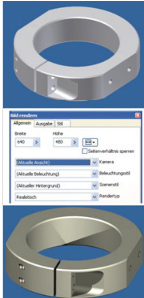
Bild 8.3: Rendering mit Voreinstel- lungen auf Knopfdruck (unten), oben die schattier- te Konstruktion
