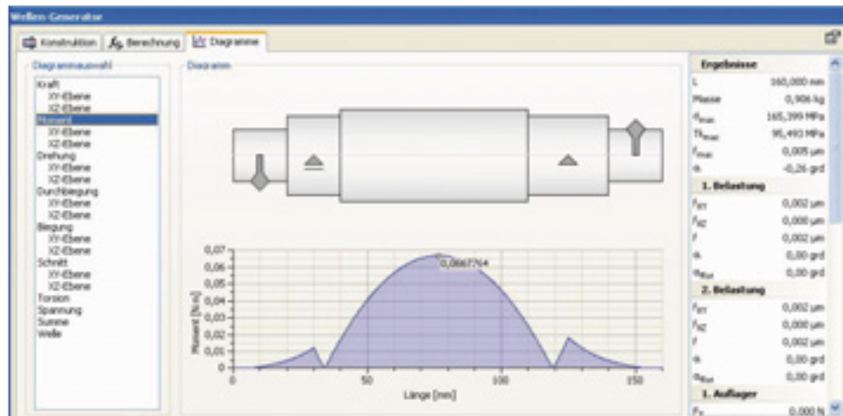
Bild 6.9: Wellenberechnung, Verlauf des Biegemoments
