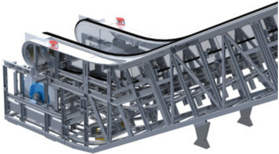
Bild 2.1: Rolltreppe konstruiert mit Autodesk Inventor (Quelle: Kone)
