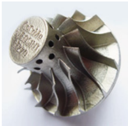
Bild 11.5: Direktes Metall-Laser-Sintern: Verdichterauflaufrad, aus CoCr (Quelle: EOS Electro Optical Systems GmbH)
