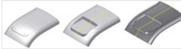
Bild 5.77: Konstruktion eines Absatzes für einen Schraubensitz oder einer Anschlagstelle für eine Halterung
