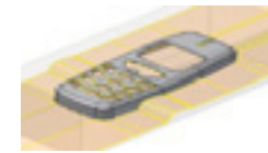
Trennflächen mit Standardoberflächen und Trennkontur bilden
