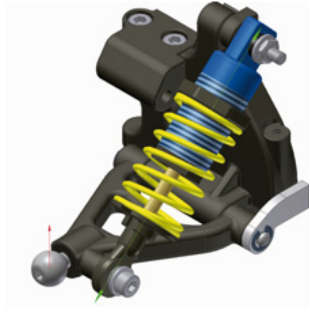
Bild 7.3: Radaufhängung mit Federung und Dämpfung (Quelle: Autodesk)
