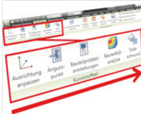
Bild 7.16: Spritzgusssimulation – Logische Schritte
