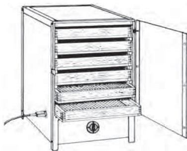
Dörrapparat mit Stufenschalter für 10 kg Frischware.
