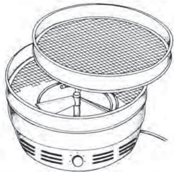
Links: Ein alter Dörrkasten aus Holz, wie er vor einigen Jahrzehnten noch Verwendung fand. Rechts: Bei dieser Skizze einer elektrischen Darre erkennt man sehr gut die Trockensiebe, die Heizspirale und den Luftpropeller.
