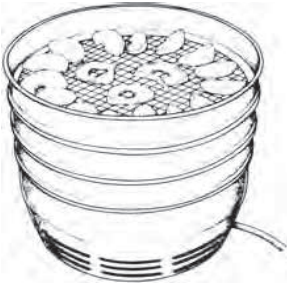
Handelsübliches, elektrisches Dörrgerät mit Heizschlange und Luftpropeller. Es können dabei bis zu 10 Siebe übereinander gestapelt werden.
