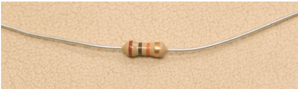
Abb. 2.11. Ein industriell gefertigter Widerstand zur Strombegrenzung
