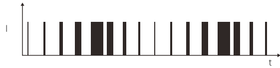
Abb. 2.38. Zeitlicher Verlauf eines impulszeitmodulierten Reizstroms
