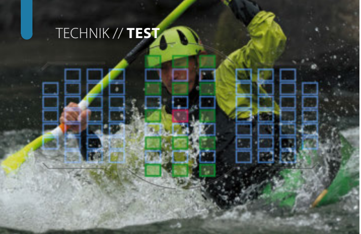
DAS AF-MODUL der Sony Alpha 77 II deckt mit seinen 79 Phasenvergleichsensoren rund 40 Prozent des Bildfelds ab. Davon sind 15 als Kreuzsensoren (grün) ausgeführt, der zentrale (rot) mit einer Genauigkeit bis hin zu f/2,8
