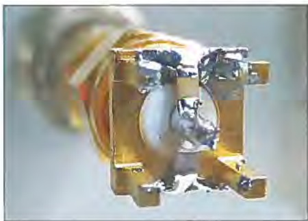
Bild 1: Zwei SMD-Kondensatoren der Größe 0805, aufgelötet am Boden einer SMA-Buchse
