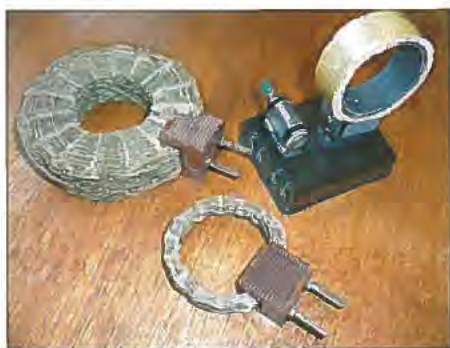
Bild 6: Ein solcher Detektor-Empfänger mit mehreren Wechsellspulen ersetzte nach Kriegsende zunächst das Röhrenradio.
