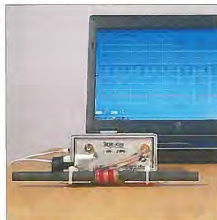
Bild 1: Auch das sehr schwache DCF77-Signal an einer passiven Antenne lässt sich präzise vermessen.
