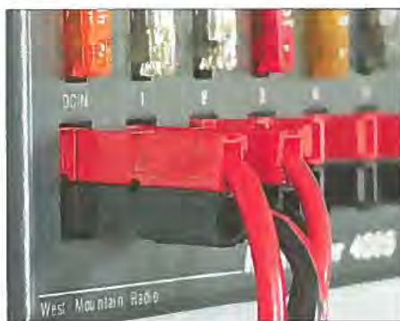
Bild 6: Dicke Transceiverkabel bedeuten bereits eine nennenswerte Last für die Powerpole-Verbinder. Ausreichende Zugentlastung ist daher unumgänglich. Fotos: Red. FA
