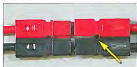
Bild 4: Wenn man von der Nut-Feder-Rastung Gebrauch macht, sind die systemgebundenen Spannsteife eher kontraproduktiv.
