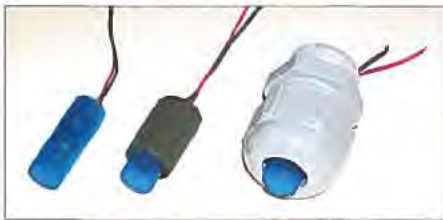
Bild 4: Passt der Durchmesser des Vibrationsmotors nicht zu dem der Kabelverschraubung, ist vorher etwas Schrumpfschlauch aufzubringen. Fotos: Sander
