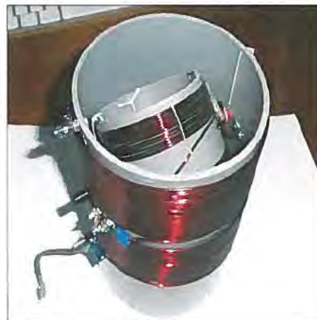
Bild 2: Ladespule mit Variometer auf einem drehbaren Spulenkörper
