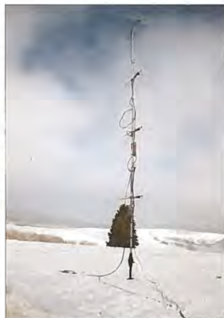
Die 4 x 6-Element-Gruppe von DR5T: Bei einer solchen winterlichen Wetterlage zählt sich die relative Unempfindlichkeit der DK7ZB-Antennen gegen Vereisung aus.
