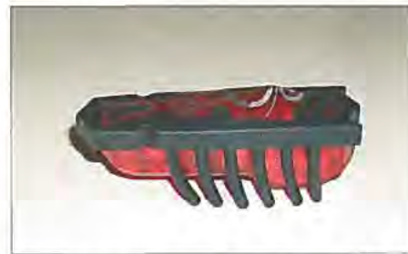
Bild 2: Die Form der Borsten und ihre ungleichmäßigen Knickwinkel bestimmen bei diesem, durch einen Vibrationsmotor angetriebenen Roboter die Laufrichtung.
