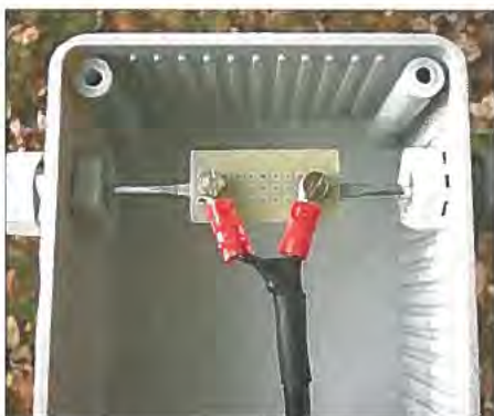
Bild 7: Der Anschluss des Koaxialkabels mit an Seele und Mantel angelöteten Quetschkabelschuhen an die Enden des Strahlerelements
