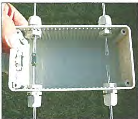
Bild 1: Verbindung der zwei Reflektor-Abschnitte mittels Lüsterklemme (links)
