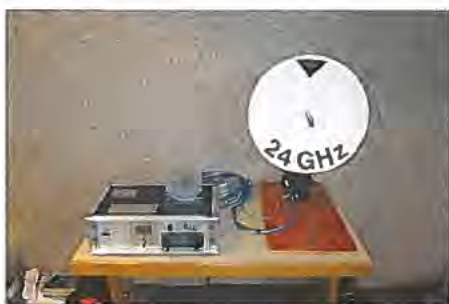
Der 24-GHz-Transverter von DL0GTH Fotos: N38
