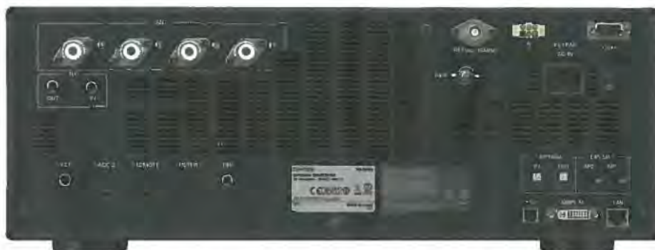
Bild 2: Die Rückfront des TS-990S wirkt recht übersichtlich. Die vier Antennenanschlüsse lassen sich dank erhabener Punkte auch durch Ertasten auseinanderhalten.
