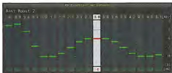
Bild 13: Das Unterprogramm für die Einstellung des Empfangs-Equalizers Bass Boost 2; der Pegel des weißen Kanals lässt sich nun mit Multi/Ch verändern. Einen gleichartigen Equalizer gibt beim Sender.
