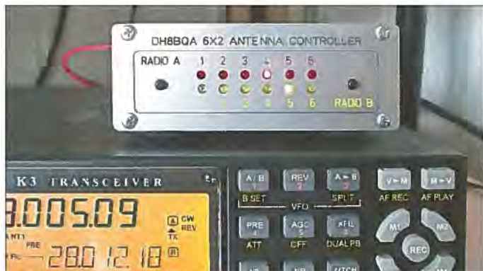
Bild 1: Steuergerät für den 6 x 2-Antennenschalter während des Funkbetriebs; der Elecraft K3 ist Radio B, während der Kenwood TS-590 als Radio A mit eigenem Steuergerät im anderen Shack steht.
