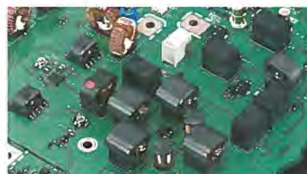
Bild 4: 1. Mischer (links) und die induktiv gekoppelten Vorverstärker des Hauptempfängers; die großen Kerne vermeiden IM durch magnetische Sättigungserscheinungen.
