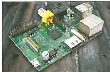
Bild 1: Die Leiterplatte des Raspberry Pi ist lediglich so groß wie eine Kreditkarte.
