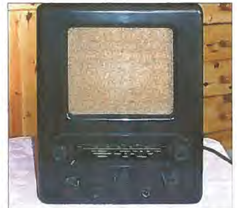
Bild 4: Volksempfänger VE 301 dyn mit dynamischem Lautsprecher und horizontaler Glasskala mit Sendernamen
