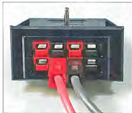
Bild 3: Bei „vorschriftsmäßiger“ Montage im Einbaurahmen (Nut und Feder ineinander rastend) ist höchste Vorsicht angesagt!
