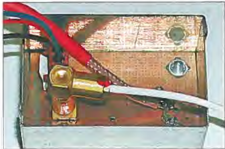
Bild 2: Die in einen Weißblechrahmen eingebaute Platine muss keinen Deckel erhalten.
