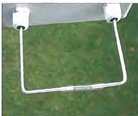
Bild 6: Schlauchstücke stellen die mechanische Verbindung zwischen den äußeren Enden der Elemente her. Dadurch wird auch beim Transport der korrekte Abstand gewahrt.
