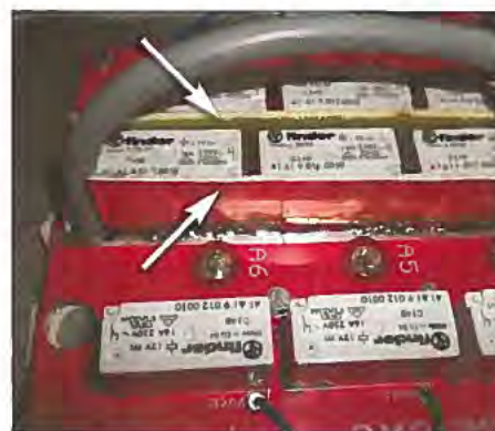
Bild 14: Kupferstreifen zwischen den Relais, hier aus Leiterplattenmaterial, erhöhen die Port-zu-Port-Dämpfung um weitere 10 dB bis 15 dB. Fotos: DH8BQA
