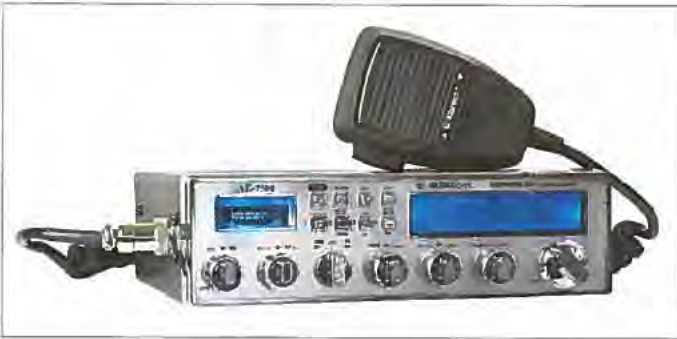
Mit seinem AE 7500 wendet sich Albrecht/Alan auch an die SSB-Freunde unter den CB-Funkern sowie an Funkamateure. Die Frontplatte ist dicht mit Bedienelementen belegt und ermöglicht so den direkten Zugriff auf viele Funktionen.
