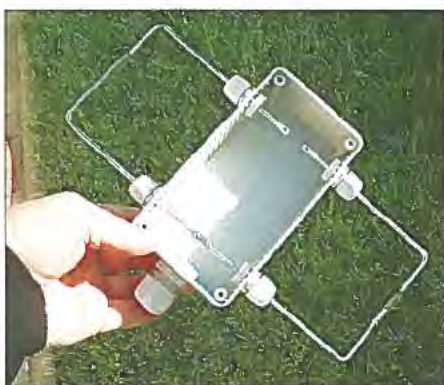
Bild 4: Strahler und Reflektor sind bereits montiert
