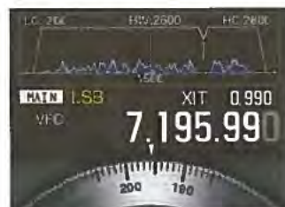
Bilder 5: Das Hauptdisplay mit dem Grundmenü; die Anzeige der Geräteparameter wird bei Platzmangel minimiert.
