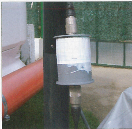
Bild 5: Die Mantelwellensperre ist in einem Gehäuse aus zwei Rohrkappen DN50 untergebracht.
