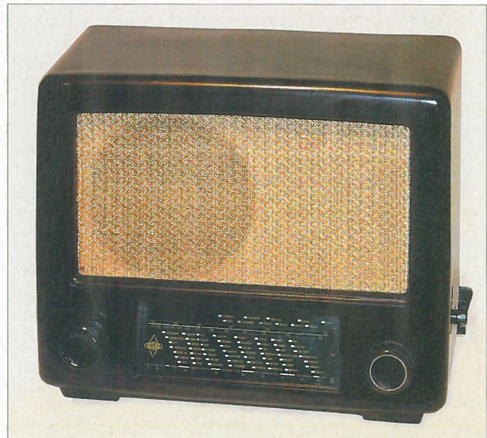
Standard-Super von 1948 – er wurde von verschiedenen Herstellern mit einheitlichen Bauteilen und gleicher Schaltung gefertigt.
