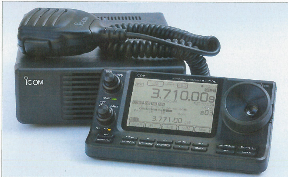
Bild 1: Der IC-7100 besteht aus dem innovativen pultförmigen Bedienteil mit seinem berührungsempfindlichen Display und dem eigentlichen Transceiver, im Handbuch Haupteinheit genannt. Fotos: Icom (2), TO (16)
