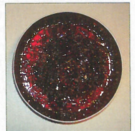
Bild 2: Das aufgeschmolzene Brühpech lässt sich nicht mehr von dem als Stück angebotenen Kolophonium unterscheiden.
