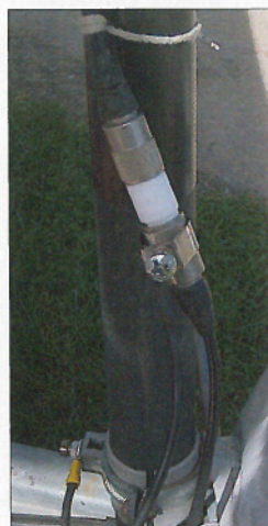
Bild 6: Das Zwischenstück besteht aus einem PTFT-Rohr mit Innenleiter. An der unteren Buchse ist die Verbindung zum Gegengewicht zu sehen.
