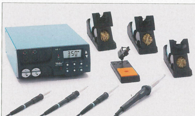
Bild 1: Multifunktionale Löt-/Entlötstation WR 2 von Weller mit elektronisch gere- gelter Temperatur und separaten Ständern für die LötKolben
