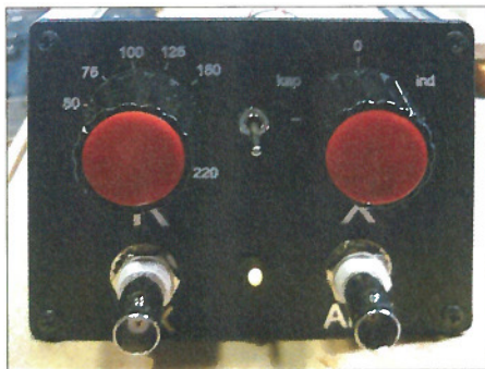
Ansicht der Bedienelemente des universellen HF-Messgeräts von Funken-Lernen; die Frontplatte wird sich noch ändern, sodass sich auch ein zweizeiliges LC-Display darauf unterbringen lässt. Foto: DF3GU
