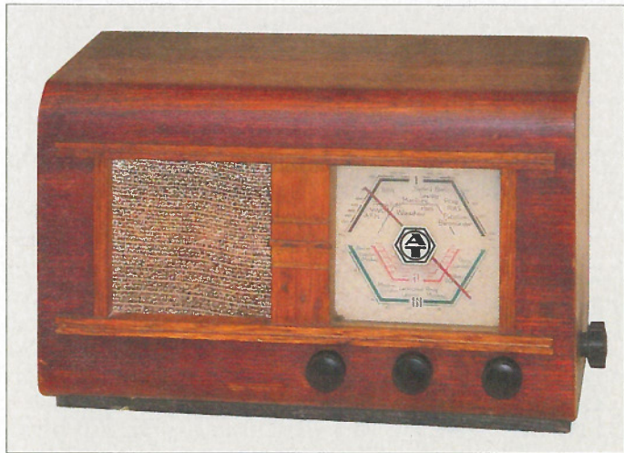
Notradio AT-217GWK mit zwei Röhren RV12P2000 (1947)
