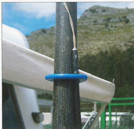
Bild 3: Der Kunststoffring hält das Koaxialkabel in der Mitte des Mastes fest, sodass es nicht an der oberen Strahlerhälfte zieht.
