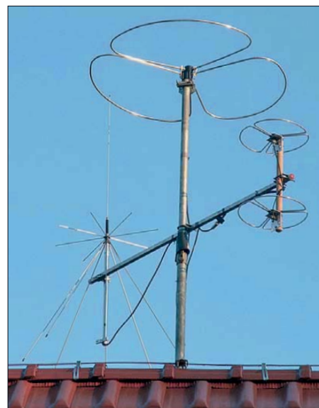
Bild 2: Die 2-m-Big-Wheel auf der Mastspitze und die zwei gestockten 70-cm-Big-Wheels vorn rechts am Ausleger; hinten die Discone-Antenne D-130N [1]
