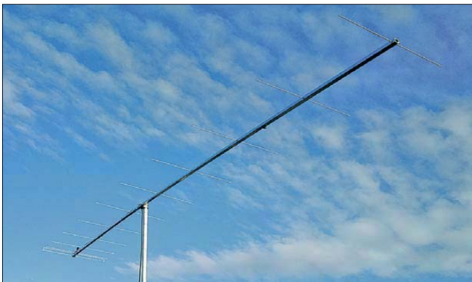
Bild 1: Ansicht der 11-Element-OWL- Yagi nach G0KSC; man beachte den eng an den Strahler gesetzten Reflektor.
