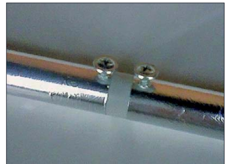
Bild 3: Die Kontaktierung kann wie hier über Schneidschrauben oder mit Nieten erfolgen. Fotos: DO1CEP
