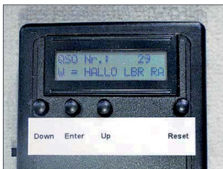
Bild 7: Während der akustischen Ausgabe der Telegrafiezeichen ist der Text auf dem LC-Display lesbar.
