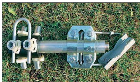
Bild 4: Das 2-m-Mittelteil von [4] besitzt von Hause aus keine Befestigungsmöglichkeit, was flexibler ist, aber Kreativität erfordert.
