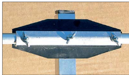
Bild 2: Montage der Parasitärelemente
