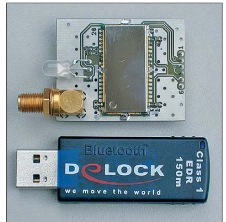
Bild 7: Bluetooth-Modul des FA-VA 3 und Class1-Bluetooth/USB-Adapter von DeLock; die Freifeldreichweite dieser Kombination mit einem \lambda/4 -Rundstrahler betrug im Versuch 340 m.
