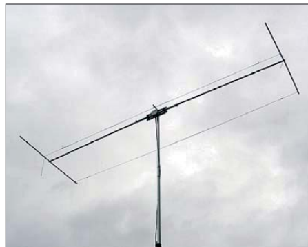
Bild 13: Doppel-T-Dipol für das 10-m-Band mit zusätzlicher 2-Element-Yagi nach dem Open-Sleeve -Prinzip für 50 MHz
