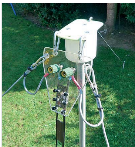
Mittenisolator an der Mastspitze mit eingehängten Dipolhälften Fotos: DJ5RE
