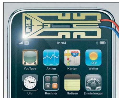
iPhone mit Energieauskoppler; die Drähte oben rechts führen zur Ladeelektronik.
