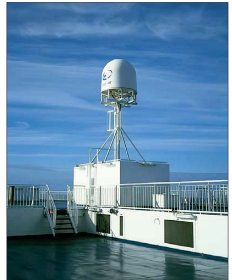
Von hier aus gehts nach oben ins Weltall – die Inmarsat-Antenne auf der Fähre Norröna
