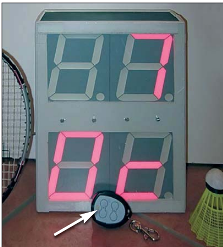
Bild 1: Match Display – fertig aufgebaut und einsatzbereit; der verwendete Funksender liegt vor dem Display.
