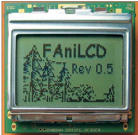
Bild 1: Vorderseite des Namens- und Rufzeichenschildes FAniLCD mit der beim Starten angezeigten Firmware-Version
