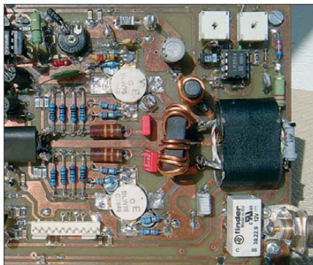
Bild 4: Bestückte Leistungstransistoren und Ausgangsübertrager im Musteraufbau des 20-W-Verstärkermoduls (27-V-Version)
