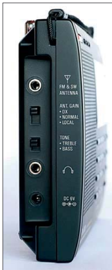
Bild 3: Anschlussbuchsen, Antennenabschwächer, Tonblende auf der linken Geräteseite
