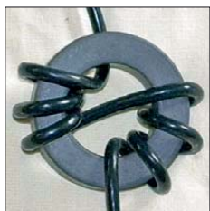
Bild 12: So wird ein 1-kW-Balun mit FT240-43 und Aircell 5 aufgebaut.
