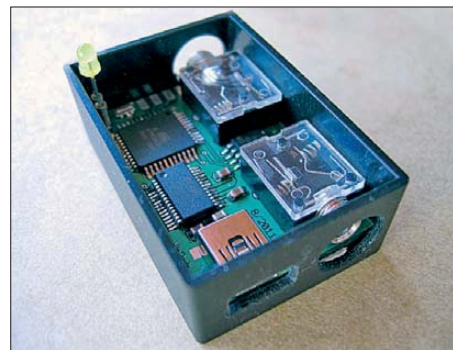
Bild 2: Bestückte Platine im handlichen Gehäuse des CW-Decoders Fotos: DL8UZ
