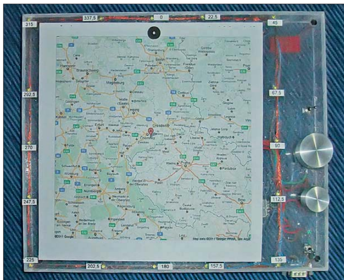
Bild 1: Frontplatte des Steuerteils für den Antennenrotor mit der von 16 LEDs umrahmten Beam-Karte und den Bedienelementen auf der rechten Seite
