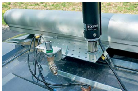
Bild 9: Befestigung Diamond SD-330 auf dem Dach des Wohnmobils
