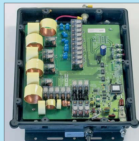
Bild 33: Innenleben des für Außenmontage geeigneten unsymmetrischen Automatikkopplers „Smartuner“ SG-237 von SGC
