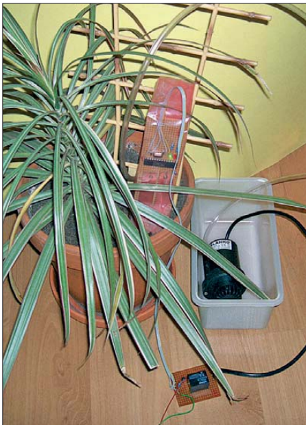
Bild 1: Versuchsaufbau des in einer Plastiktüte untergebrachten Bodenfeuchtesensors mit der Pumpe im Wasserbehälter und ihrer Spannungsversorgung Foto: Sander
