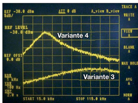
Bild 5: Störverhalten der Varianten 3 und 4 bei EM-Bestrahlung
