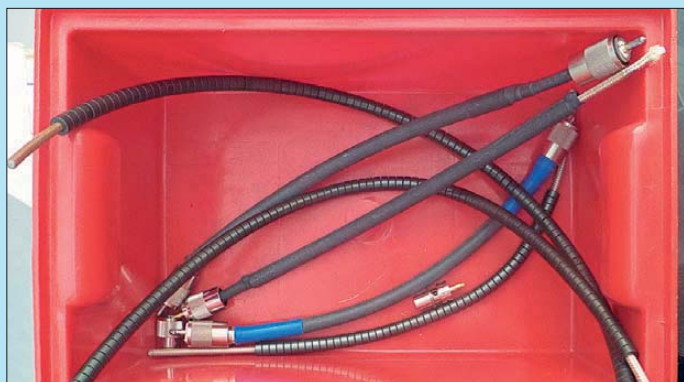
Bild 31: Diverse Mantelwellensperren aus über das Koaxialkabel geschobenen Ringkernen
