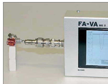
Bild 4: Resonanzmessung eines induktiv gekoppelten Schwingkreises (I.) mit der kleinen Koppelspule aus dem MFJ-66-Spulensatz; das SWV-Minimum bedeutet „Dip“, hier zur besseren Sichtbarkeit am FA-VA gezeigt.
