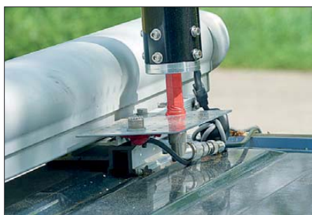
Bild 3: Provisorische Befestigung der Tarheel-300 auf dem Dach des Wohnmobils
