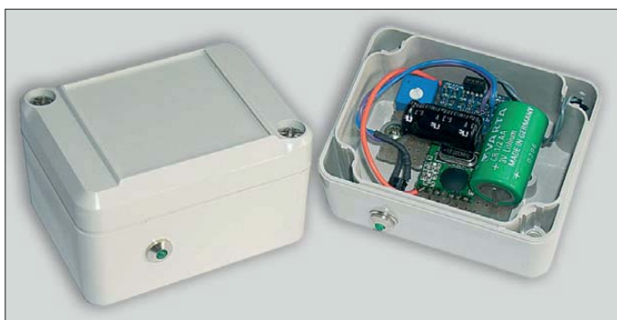
Bild 1: Batteriebetriebene Funksensoren im geschlossenen und geöffneten Gehäuse
