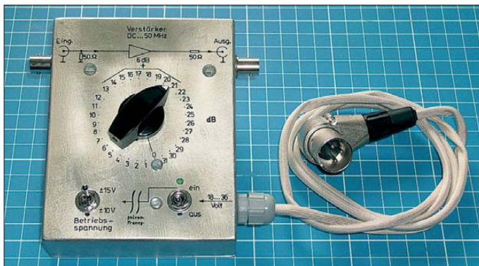
Bild 1: Fertiggerät des Breitbandverstärkers mit Dezibel-linearer Einstellmöglichkeit über einen Drehcodierschalter
