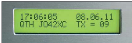
Bild 7: LC-Display, hier mit Datums- und Uhrzeitanzeige sowie Locator, 3D-fix und Höhenangabe, wechselnd im 20-s-Takt
