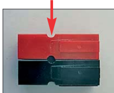
Bild 2: Die für Sicherungstifte vorgesehenen Kerben dienen nun zum Einrasten im Gehäuse.
