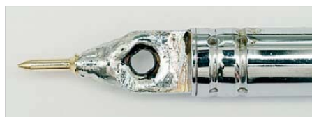
Bild 4: Zum Anschluss an den BNC-Adapter wird am Fußpunkt der Teleskopantenne der Kontaktstift aus einem BNC-Stecker angelötet.
