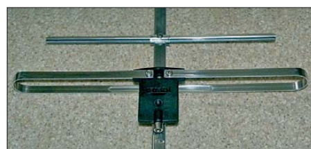
Bild 1: Vergossener Dipolanschluss mit der FME-Buchse
