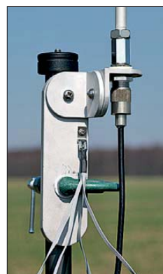
Bild 5: Montagewinkel mit Antenne, Koaxialkabel und vier Radialen
