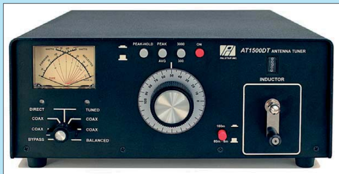
Bild 20: Der unsymmetrische Antennenkoppler Palstar AT1500DT verwendet die T-Hochpassschaltung gemäß Bild 21 in Verbindung mit einem Differenzialdrehkondensator – das erspart einen Drehknopf.
