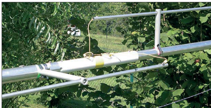
Bild 1: Isoliertes Mittelstück und Befestigung der äußeren Aluminium- rohre
