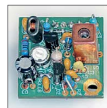
Bild 10: ZF-Verstärker im Weißblechgehäuse auf der Grundplatte
