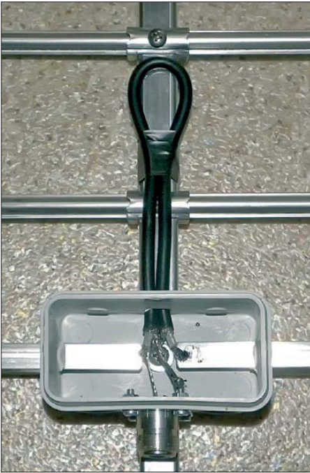
Bild 2: Die neue Anschlussdose mit N-Buchse und Balun
