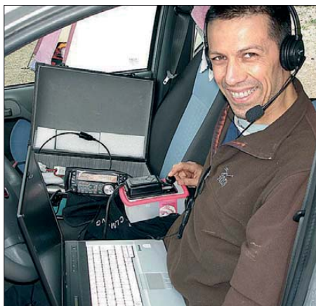
Bild 4: Die Plastiktüte bewährt sich im Portabel-Shack als Morsetastenhalter.
