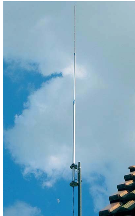
Bild 4: KFA-5000 auf 28,5 MHz abgeglichen
