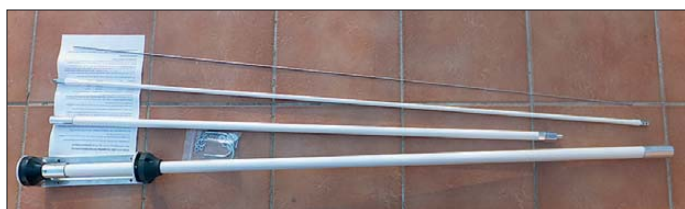
Bild 1: KFA-1000 – der 1,35 m lange dünne Stab ist beim Abgleich zu kürzen.
