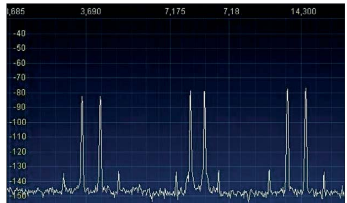
Bild 2: Der IMA3 der Treiberstufe liegt zwischen dem 80-m- und dem 20-m-Band bei mindestens 52 dBc.
