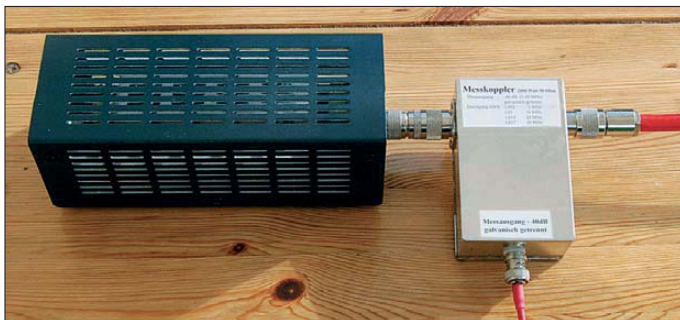
Bild 1: Fertig aufgebauter Messkopplers (r.) mit angeschlossenem Lastwiderstand
