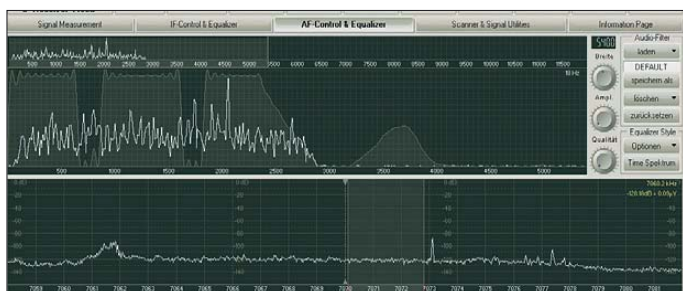
Bild 6: Ergebnissenster eines Scans des KW-Bereichs von 0,5...21 MHz mit starken Rundfunkstationen bei 4 MHz und 7 MHz
