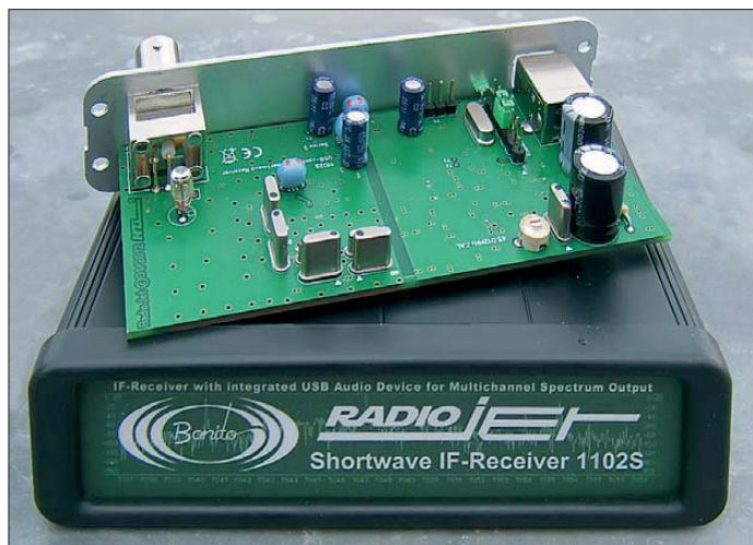
Bild 2: SMD-bestückte Unterseite des Radiojet 1102S; in der Mitte der Si570, links daneben der Mischer AD8343, rechts daneben der USB/Audio-Controller
