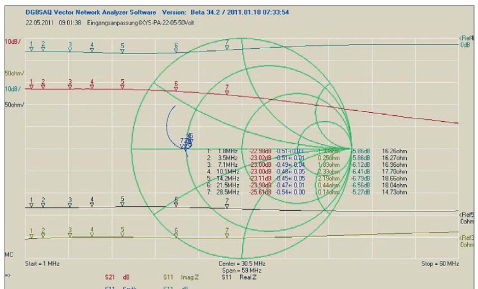
Bild 7: Frequenzgang der Gegentakt-Endstufe mit Eingangskompensation; das gewählte Anpassungsnetzwerk ist ein Tiefpass mit 33 MHz Grenzfrequenz und einer Impedanz von 2 \times 8,2 \Omega .
