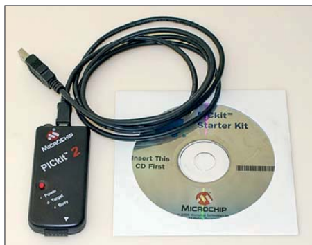
Bild 1: Der PICkit 2 ist ein moderner Programmieradapter für die USB-Schnittstelle.
