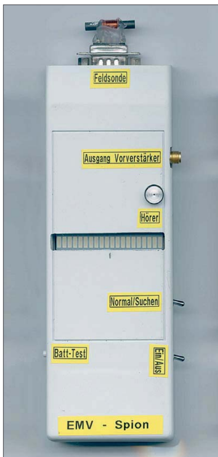
Bild 1: Labormuster des EMV-Spions mit aufgesteckter NF-Breitbandantenne
