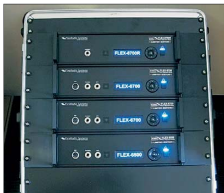
Hier präsentierte FlexRadio Systems die Flex-6000-Baureihe als Konfiguration für DXpeditionen. Diese Anordnung beinhaltet drei TX für 5 Sendeantennen und 28 unabhängige RX. Die RX/TX sind im Netzwerk verbunden.
