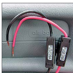
Bild 9: Durch die Stromversorgung über das Funkgerät fallen zusätzliche Kabel und damit verbundene Risiken im Mobilbetrieb weg.
