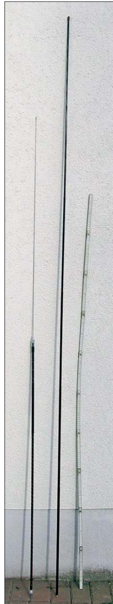
Bild 6: C-Whip-Monoband-Mobilstrahler für das 20-m-Band (links) und Teleskopantenne (Mitte) im Größenvergleich neben einem Gliedmaßenmaßstab (2 m, rechts) Fotos: DL6RAL
