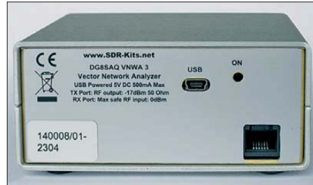
Bild 2: An der Geräterückseite befinden sich noch zwei Buchsen; USB für die Verbindung zum PC, RJ-11 zur Rotorsteuerung und für ein S-Testset sowie ggf. zur Stromversorgung.
