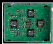
HF Verstärker mit dem großzügig dimensionierten Breitbandüberträger
