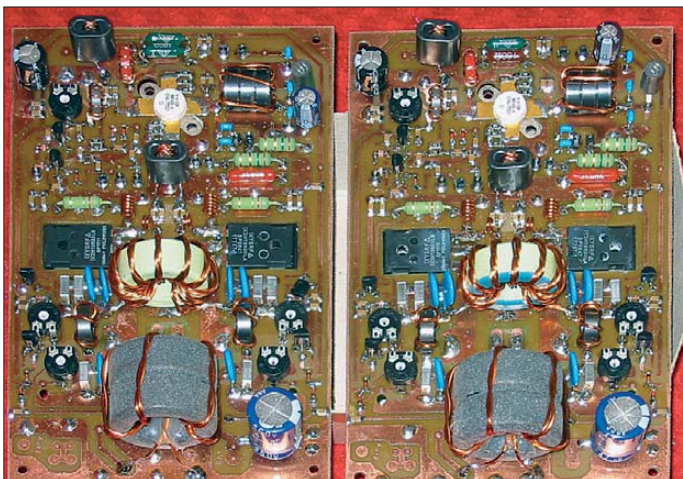
Bild 16: Zwei fertig bestückte Testplatinen; die Ausgangsübertrager wurden zu einem späteren Zeitpunkt gegen solche mit 43er-Kernmaterial ausgetauscht.
