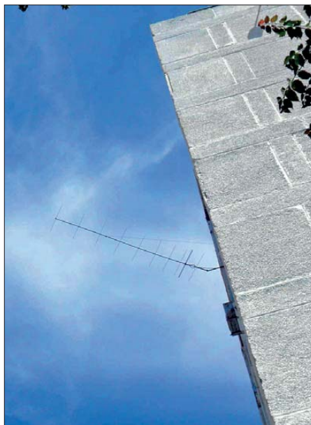
Seine „Balkon-Antenne“ hat Alexej, UN7AX, am Boommende mit einem Gelenk befestigt, sodass er sie händisch im Azimuth ausrichten kann.
