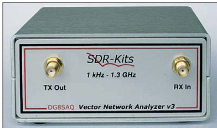
Bild 1: Der VNWA3 ist jetzt ausschließlich als Fertiggerät erhältlich. Die Frontplatte zieren lediglich zwei SMA-Buchsen, nämlich Generatortausgang TX Out und Messeingang RX In.
