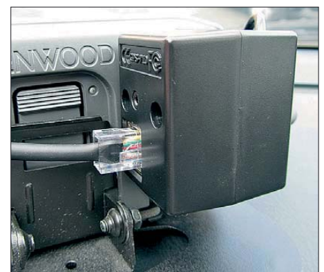
Bild 3: Das montierte GPS-Modul verschwindet völlig hinter dem Bedienteil.
