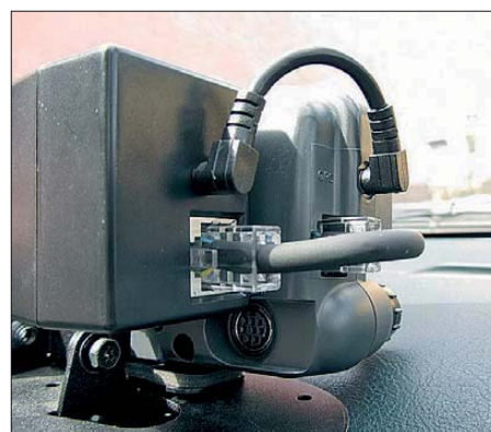
Bild 2: Die GPS-Antenne liegt oben, und die TNC-Buchse des Bedienteils ist zugänglich.
