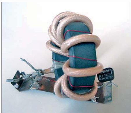
Bild 1: Labormuster des 100-W-Symmetrierübertragers mit einem Übersetzungsverhältnis von 1:1
