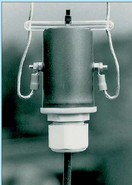
Bild 20: Direkter Übergang von der Zweidrahtleitung auf ein Koaxialkabel
