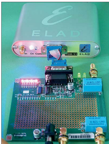
Teamwork: LEDs signalisieren die Schaltsignale auf der Experimentierplatine.
