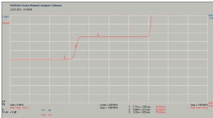
Bild 23: Messergebnis des 75-Ω-Koaxialkabels RG59
