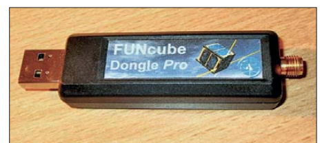
Bild 10: Der FUNcube verfügt über einen SMA-Antennenanschluss und kann direkt in eine freie USB-Buchse des PC gesteckt werden. Aus mechanischen Gründen empfiehlt es sich allerdings, ihn über eine kurze USB-Verlängerung mit dem PC zu verbinden.
