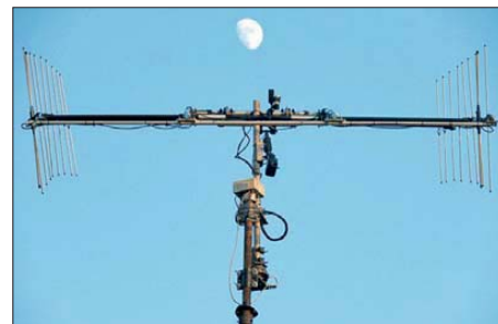
Bild 5: Um dem Faraday-Effekt zu begegnen, kann Steffen Minack, DD0VF, seine beiden 9-Element-Yagis innerhalb von 6 s von horizontaler auf vertikale Polarisation drehen, wie [5] zeigt.
