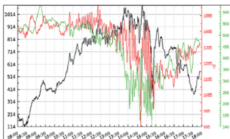
So stark schwankten die am 15.7.12 von 0800 bis 1800 UTC im nordschwedischen Lycksele (JP94HO) gemessenen x/y/z-Komponenten (sw/rt/gn) des Erdmagnetfelds. Grafik: Institutet för rymdfysik (IRF)
