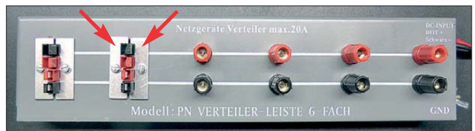
Bild 2: Jeweils vier Powerpole-Steckverbinder werden mit zwei Einbaurahmen festgehalten.
