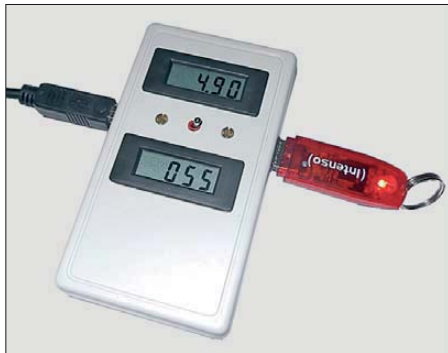
Bild 1: Ansicht des aufgebauten Musters; der angeschlossene USB-Stick zieht 55 mA.
