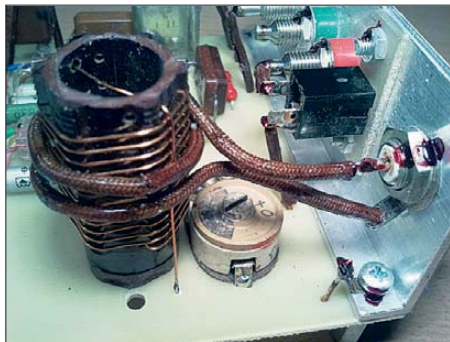
Bild 4: Antennenauskopplung und Details der Mechanik
