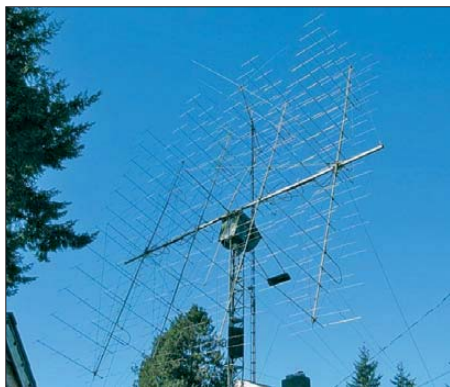
Bild 3: Lionel, VE7BQH, in Vancouver, konnte sein inzwischen abgebautes 384-Element-Collinear-Array über einen zusätzlichen Rotor im Mastkopf sogar im gesamten Bereich zwischen horizontaler und vertikaler Polarisation schwenken.
