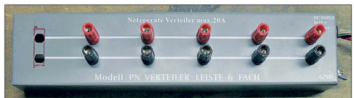
Bild 1: Von der Verteilerleiste sind zwei Laborklemmen zu entfernen und ein Durchbruch für vier Powerpole-Verbinder herzustellen.
