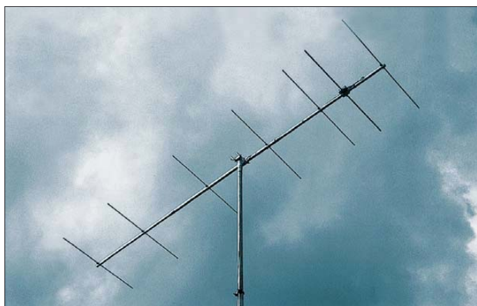
Bild 1: Die 7-Element- 28- \Omega -Yagi als eine der am meisten nachgebauten Antennen
