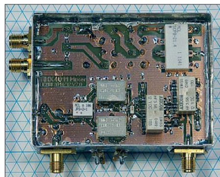
Bild 7: Fertig aufgebaute Mischerbau- gruppe mit abgenommenem Gehäusedeckel (SMD-Seite); das hier noch bestückte 1-dB- Dämpfungsglied ist im aktuellen Layout nicht mehr enthalten.
