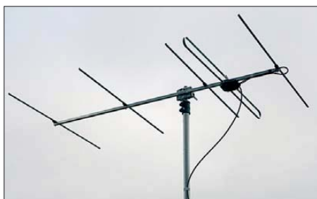
Bild 5: 5-Element-50-Ω-Yagi mit Faltdipol, industriell gefertigt von Konni-Antennen [8]
