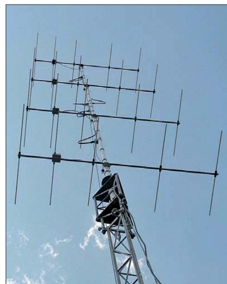
Bild 7: Die 4 x 25-Ω-Yagigruppe bei DA0Y (DK5EW)
