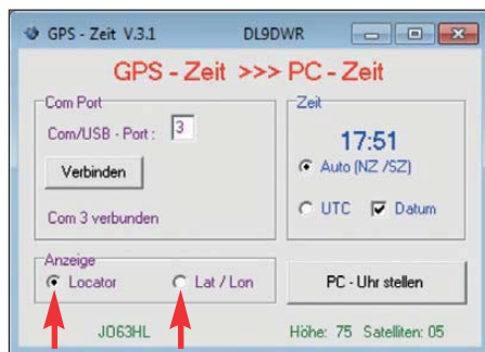
Bild 2: Bei der Positionsanzeige ist zwischen dem Locator oder den geografischen Koordinaten wählbar. Screenshots: DL9DWR
