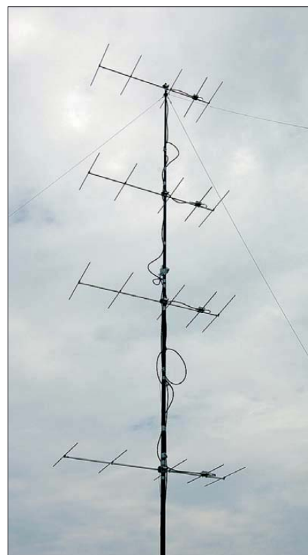
Bild 2: Die 4 \times 5-Element-12,5- \Omega -Yagigruppe von TM7T
