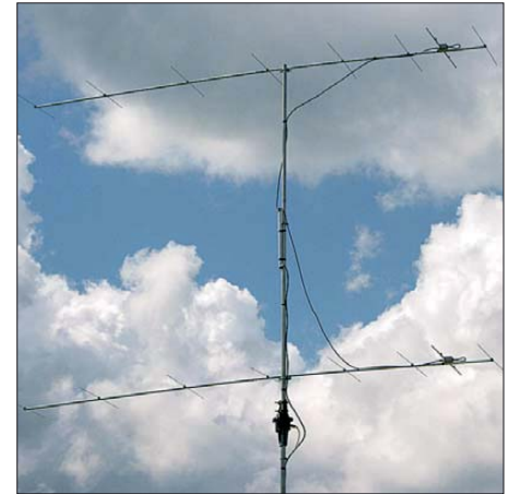
Bild 9: Zwei 8-Element-28-Ω-Yagis in Leichtbauweise
