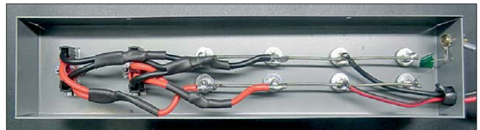
Bild 3: Im Innern des Gehäuses sind die gecrimpten Kontakte über isolierten Leitungen mit den bestehenden Drähten zu verlöten.
