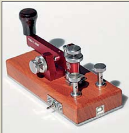
Rückseite der Stampfl-Morsetaste STM11-USB mit dem USB-Anschluss
