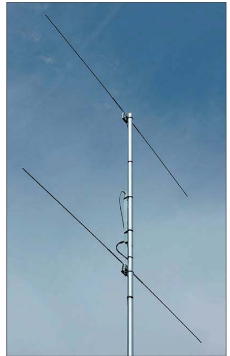
Bild 3: Die gestockte Zweiergruppe im Einsatz, in der Mitte ist der Anpasskopf erkennbar.
