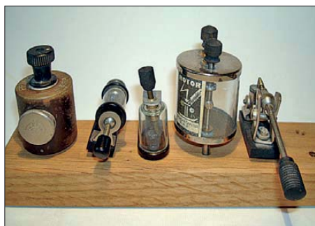
Bild 3: Steckbare Kristalldetektoren aus den ersten Jahren des Empfängerbaus
