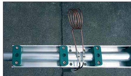
Bild 10: Jede Antenne ist mit einer Seriennummer versehen, mit der man sich bei Supportfragen an den Hersteller wenden kann. Weiterhin kann man die Stauff-Halterungen sehen, welche einen stabilen Halt versprechen.
