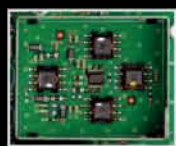
HF Verstärker mit dem großzügig dimensionierten Breitbandübertrager
