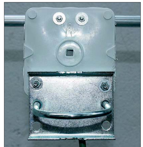
Bild 10: Rückseite der Dipoldose mit der Mastschelle
