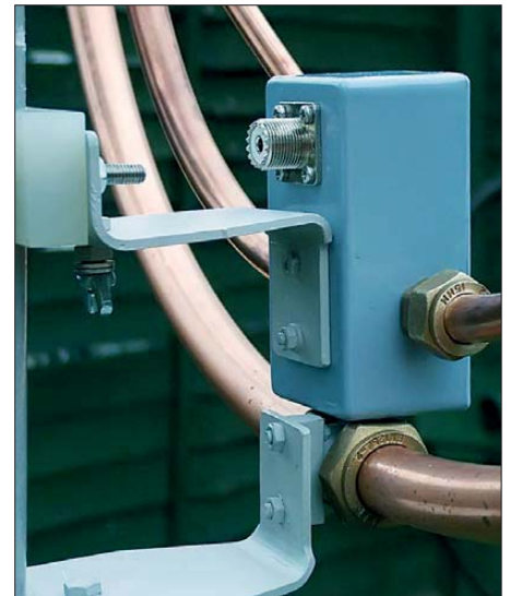
Bild 6: Einkopplung ohne galvanische Verbindung Fotos: DL3AYJ (3), M0BDQ (1), Screenshot: Red. FA
