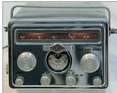
Bild 5: Der Transceiver war noch nicht erfunden. Passend zum Sender hier der Empfänger G-66B [7], äußerlich identisch mit dem von DL9HF verwendeten G-66. Als Doppelsuper konstruiert, enthielt er zusätzlich den Bereich von 0,54 bis 2,0 MHz zum Empfang des Mittelwellen- und 160-m-Bandes.
