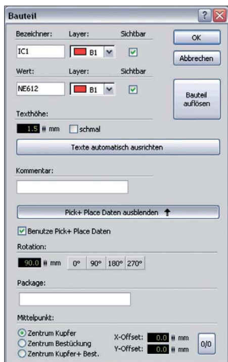
Bild 6: Zentraler Punkt für den Beschriftungs-aufdruck, die Stückliste und das Eingeben von Pick+Place -Daten ist das beim Ablegen eines Bauteils angezeigte Fenster Bauteil . Es öffnet sich auch nachträglich per Doppelklick auf das Bauelement.
