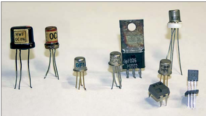
Bild 1: (v. l. n. r.) Zwei Transistoren aus den 1960-ern; Germanium-UHF-Transistor GF145 (dessen BRD-Pendant AF139 um 1965 begehrte Schmuggelware zum Bau von TV-Konvertern für das ZDF war); die legendären FETs RCA 40841 und P8002; „sterbefreudige“ FETs aus der UdSSR und der DDR
