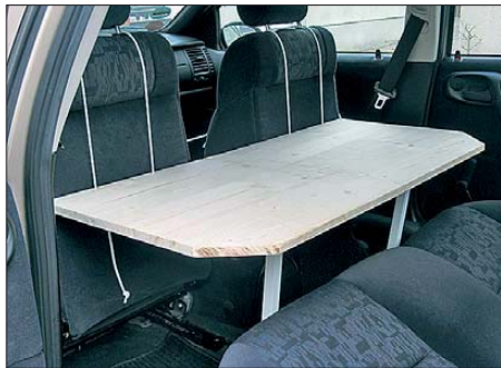
Bild 1: Auseinandergeklappter Universaltisch mit Stützen in Arbeitsposition
