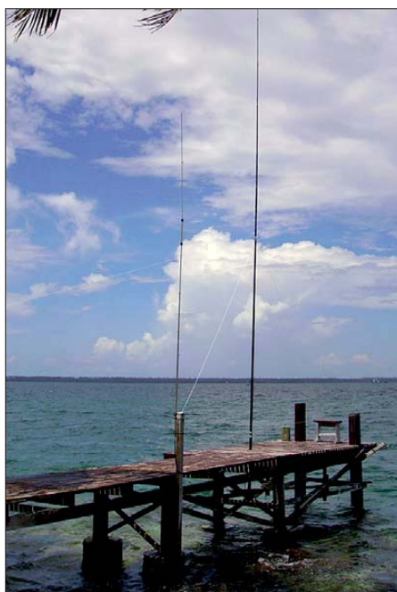
Die Vertikalantennen für 40 m sowie 12 m, 17 m und 30 m für das SSB-Camp
