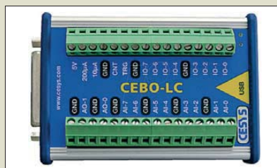
Das Cebolc ist in einem robusten Aluminiumgehäuse mit Gummi-Armaturen für einen rutschfesten Stand untergebracht.
