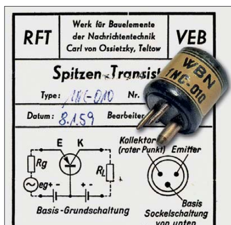
Bild 2: Spitzentransistor von 1959 mit handbeschriftetem Datenblatt – mni tnx DL1HUB!
