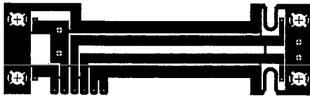
Bild 5.16: Gestanzte Leiterplatte mit 4 Glühlampenfassungen, die sich über U-Dehnelemente und 4 Stifte an den Träger anpasst
