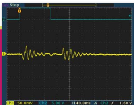
MAGNETVENTIL: Messung mit Gummifüßen.
