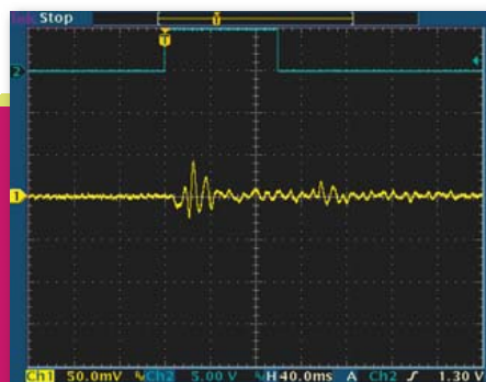
MAGNETVENTIL: Messung mit Gummifüßen.
