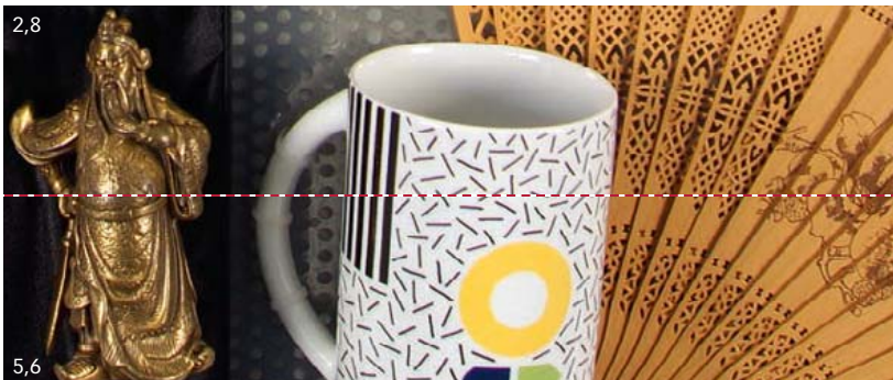
▲ DETAILS BILDRAND 16 mm: Etwas bessere Detailauflösung bei Blende 5,6, auch durch die größere Schärfentiefe (vollständiges Bild auf S. 72).
