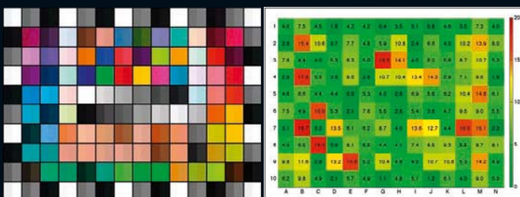
FARBWIEDERGABE Links: Jedes Feld ist unterteilt in Original (rechte Hälfte) und Kamerawiedergabe (linke H.). Rechts: die Messwerte bedeuten grün=ok, rot=abweichend.
