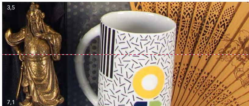
▲ DETAILS BILDRAND 16 mm: Die höhere absolute Auflösung in Linienpaaren pro Bildhöhe ist auch in den Bildern sichtbar (Sony A77 = 24 MP, Pentax K-5 IIs = 16 MP).
