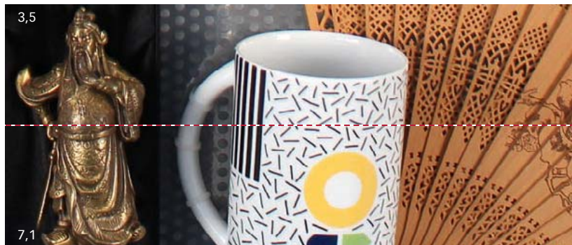
▲ DETAILS BILDRAND 18 mm: Die Tasse läuft etwas aus der Schärfentiefe bei offener Blende, ansonsten aber gute Detailauflösung bei beiden Blenden.
