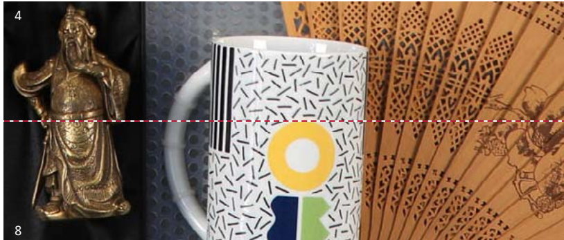
▲ DETAILS BILDRAND 105 mm: Bei Blende 4 sichtbar schwächere Auflösung als bei Blende 8 (vollständiges Bild auf S. 72).
