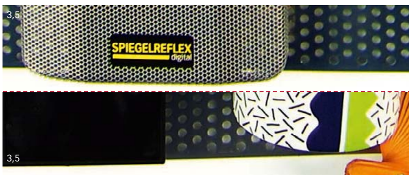
▲ CHROMATISCHE ABERRATION 3,5/18 mm: Der Farbvergrößerungsfehler (Chromatische Vergrößerungsdifferenz) tritt als gut sichtbarer Farbsaum auf. Die von den verschiedenen Wellenlängen erzeugten Bilder haben nicht den gleichen Abbildungsmaßstab.
