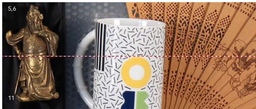
▲ DETAILS BILDRAND 55 mm: Bei Blende 5,6 etwas besser, weil die Beugung bei Blende 11 die Auflösung verringert (vollständiges Bild auf S. 72).
