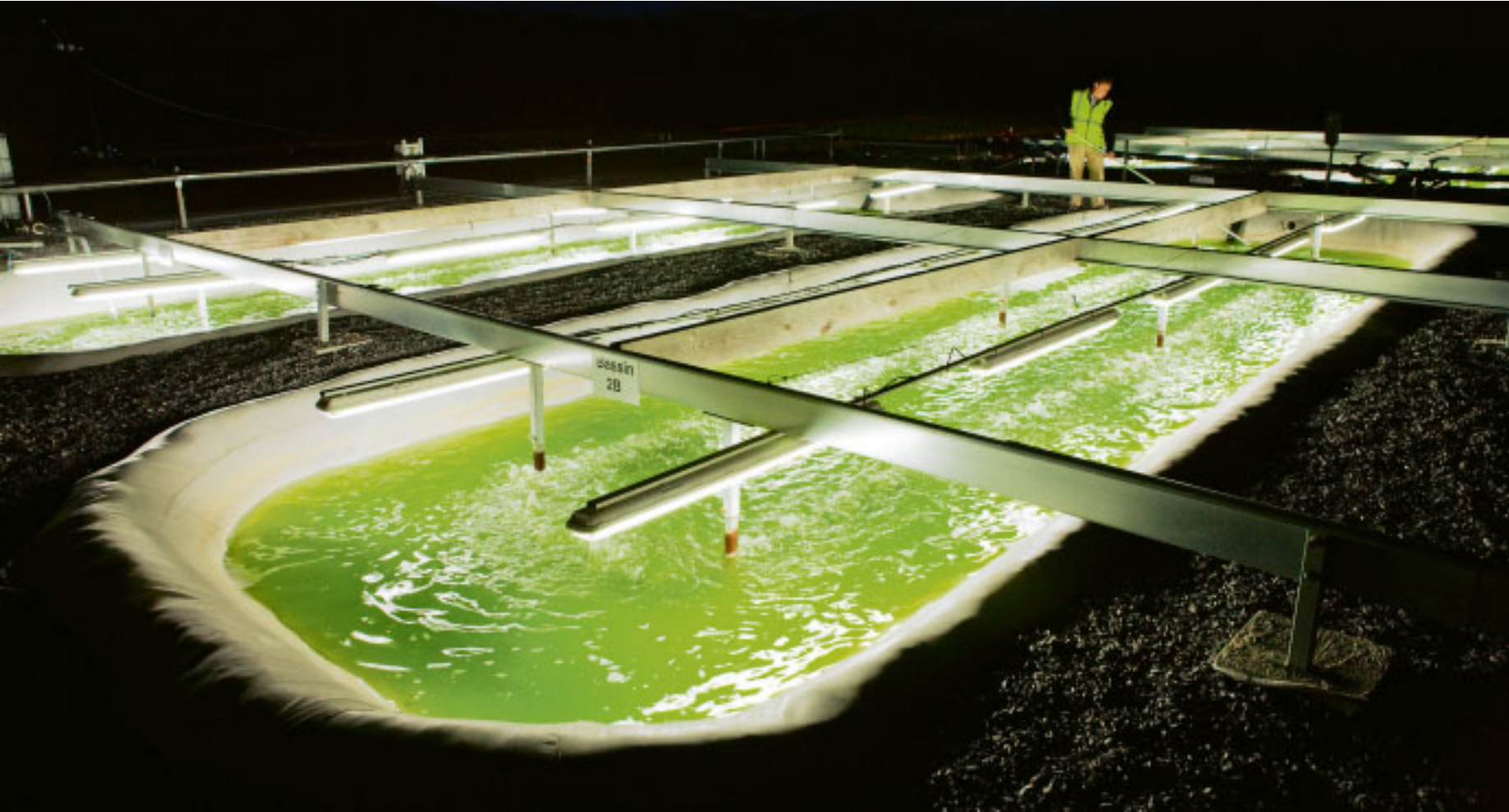
Eine Anlage mit Grünalgen der Art Chlorella vulgaris. In die Teiche wird Kohlendioxidgas gepumpt, das die Mikroalgen zur Vermehrung nutzen.
