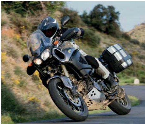
Der weite Weg zur Wüste: Yamaha XT 1200 Z Super Ténéré Zweizylinder-Reihenmotor, 1199 Kubikzentimeter Hubraum, Nennleistung 81 kW (110 PS) bei 7250/min, maximales Drehmoment 114 Nm bei 6000/min, Gewicht vollgetankt 266 kg, Tankvolumen 23 l, Sitzhöhe 845/870 mm, Radstand 1540 mm, Federweg vorn/hinten 190/190 mm, Grundpreis 14 210 Euro (inkl. ABS-Bremsanlage mit Kombifunktion, dreistufige Traktionskontrolle, zwei wählbare Motor-Kennfelder, Hauptständer, Speicherriemen).
