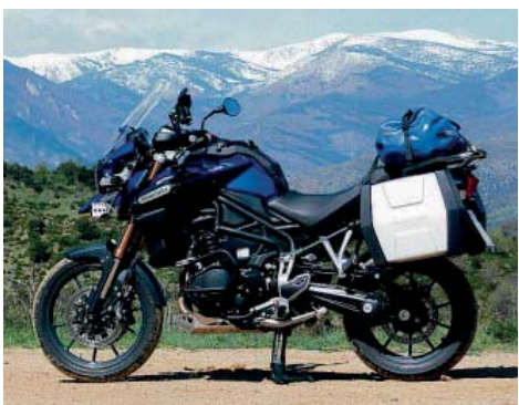
All inclusive: Triumph Tiger Explorer Zweizylinder-Reihenmotor, 1215 Kubikzentimeter Hubraum, Nennleistung 101 kW (137 PS) bei 9000/min, maximales Drehmoment 121 Nm bei 6400/min, Gewicht vollgetankt 273 kg, Tankvolumen 20 l, Sitzhöhe 840/860 mm, Radstand 1530 mm, Federweg vorn/hinten 190/194 mm, Grundpreis 14 140 Euro (inkl. ABS-Bremsanlage, zweistufige Traktionskontrolle, Tempomat, Hauptständer, automatische Blinkerabschaltung, Gepäckbrücke).
