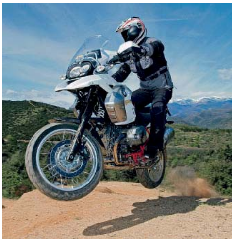
Der springende Punkt: BMW R 1200 GS Rallye Zweizylinder-Boxermotor, 1170 Kubikzentimeter Hubraum, Nennleistung 81 kW (110 PS) bei 7750/min, Drehmoment 120 Nm bei 6000/min, Gewicht vollgetankt 244 kg, Tankvolumen 20 l, Sitzhöhe 855/875 mm, Radstand 1507 mm, Federweg vorn/hinten 190/200 mm, Grundpreis 13 569 Euro, Sondermodell „Rallye“ wie abgebildet (inkl. ESA, Bordcomputer, Heizgriffe etc.) plus Sicherheitspaket (ABS, Traktionskontrolle, Reifendruckkontrolle) 16 654 Euro. Foto: Till Kohnhauer/Tourenfahrer
