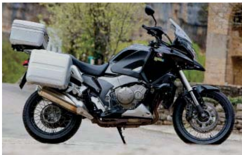
Düsentrieb und Business-Koffer: Honda Crosstourer Vierzylinder-Motor, 76 Grad Zylinderwinkel, 1237 Kubikzentimeter Hubraum, Nennleistung 95 kW (129 PS) bei 7750/min, Drehmoment 126 Nm bei 6500/min, Gewicht vollgetankt 276 kg, Tankvolumen 21,5 l, Sitzhöhe 850 mm, Radstand 1595 mm, Federweg vorn/hinten 165/145 mm, Grundpreis 13 845 Euro (inkl. ABS-Bremsanlage mit Kombi-Funktion, Traktionskontrolle, auf Wunsch Doppelkupplungsgetriebe (Aufpreis 1000 Euro)).
