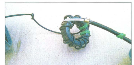
Bild 4: Breitband-Spartransformator mit Kabelbinder am RG58 zur Zugentlastung
