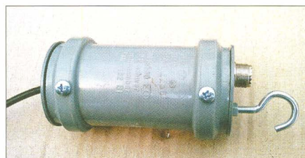
Bild 3: Gleichtaktdrossel im montierten Zustand mit Blechtreibschrauben zur Fixierung
