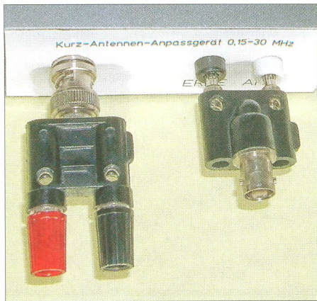
Bild 7: Rückseite des Anpassgeräts mit den beiden BNC-Adapttern Fotos: DG0KW
