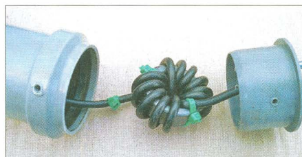
Bild 2: Gleichtaktdrossel aus zwölf Windungen Koaxialkabel RG58CU auf Ringkern RK3
