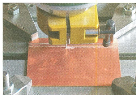
Bild 4: Die Platine ist an allen Ecken einzuspannen und in einer Richtung zu fräsen.
