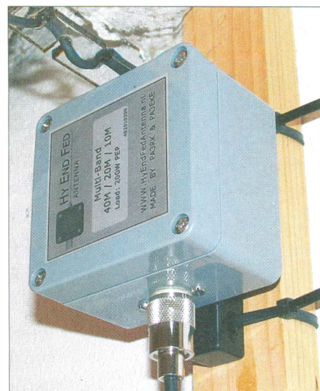
Bild 3: An der Mauer im Dachboden befestigtes Unun-Gehäuse Fotos: DL6RAL
