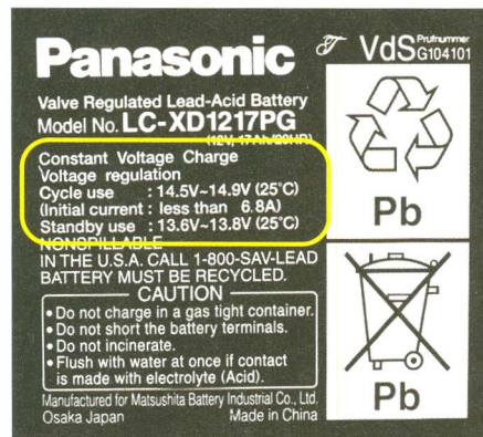
Bild 4: Die Aufschrift eines Bleigel-Akkumulators enthält oft auch die Vorschriften zur richtigen Ladung. Foto: DJ3TZ
