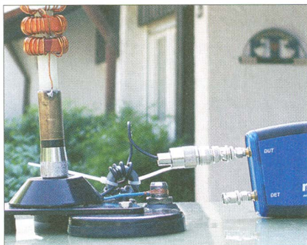
Bild 1: Messung an einer Eigenbau-Mobilantenne, die hier um den im Text beschriebenen 1:4-Transformator ergänzt ist
