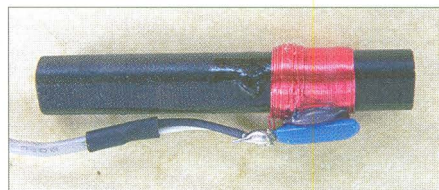
Bild 17: Der Abgleich des Antennenschwingkreises erfolgt durch Verschieben und anschließendes Festlegen der Antennenspule.
