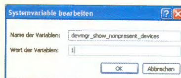
Bild 6: Setzen einer Systemvariablen in der Systemsteuerung; exakt genauso ist mit devmgr_show_details zu verfahren.
