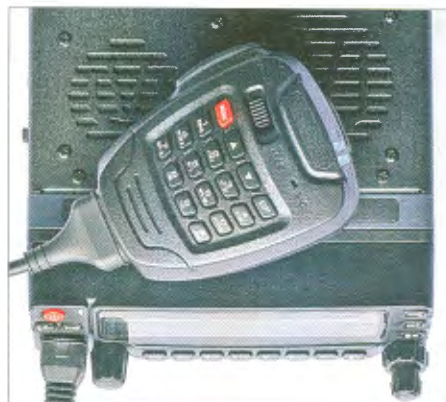
Bild 2: Das große DTMF-Mikrofon erleichtert die Bedienung. Dank Hintergrundbeleuchtung ist dessen Beschriftung auch im Dunkeln ablesbar.
