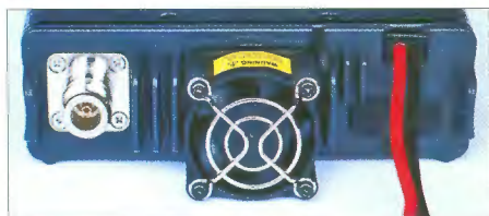
Bild 3: Anschlussmöglichkeiten auf der Rückseite des Transceivers; im Zentrum der vorstehende Lüfter
