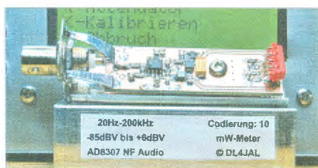
Bild 8: NF-/Audio-Messkopf mit AD8307; hier wurde die Codierung der Messkopfnr mit Null-Ohm-Widerständen realisiert.
