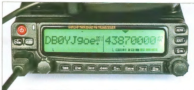
Bild 6: Im Einstellmenü sind für jeden Betriebszustand verschiedene Displayfarben definierbar, darunter Grün beim Empfang.
