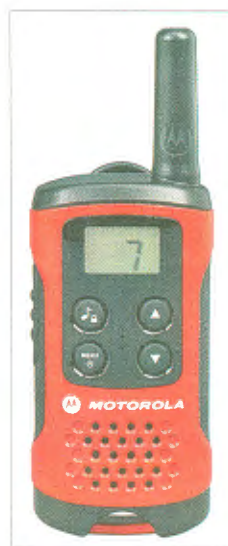
Bild 1: Einfaches PMR446-Gerät für Einstieger; das Motorola TLKR T40 eignet sich für FM-Funkverkehr im Umkreis von etwa 4 km.
