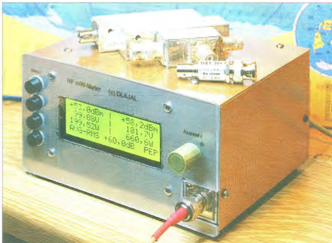
Bild 1: Prototyp des HF-Milliwattmeters mit zwei Wechselschaltern, einem Combiner mit Widerständen zur Messsignalverzweigung und einem 30-dB-Dämpfungsglied zur Kalibrierung; in der Anzeige ist das Messergebnis eines Zweitonsignals zu sehen. Vorgeschaltet sind 60 dB Leistungsdämpfung.
