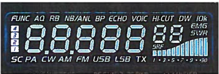
Das LC-Display (hier: Komplettansicht) zeigt neben der Frequenz zahlreiche Funktionen an.
