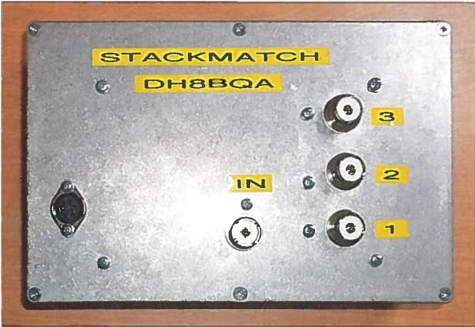
Bild 3: Stackmatch-Platine nach SM2WMV; die gestockten Ringkerne bieten auch im Dauerbetrieb mit maximaler Leistung ausreichend Reserve.
