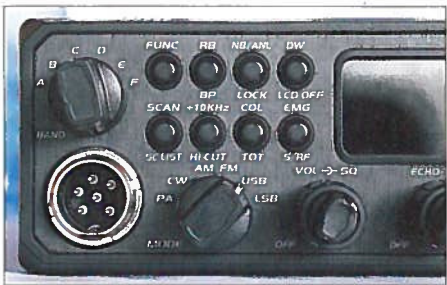
Der Schalter Band dient zum Wechsel zwischen den Speichergruppen; Sendarten werden manuell gewählt und lassen sich nicht zu einem Kanal speichern.
