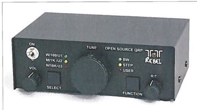
QRP-Transceiver Ten-Tec 506 Rebel , speziell für experimentierfreudige Amateure
