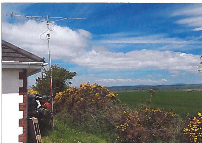
Er sieht eher ein wenig provisorisch aus, der Aufbau mit der neben dem Haus angebrachten 11-Element-Yagi-Antenne bei EI3KD. Doch selbst EME in JT65 ist damit möglich, sogar wenn die Gegenstation nur über zwei Antennen verfügt.
