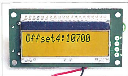
Bild 6: Frequenzzählermodul im Programmiermodus; hier wurde z.B. ein Wert von 10.7 MHz als Offsetbetrag 4 eingestellt.
