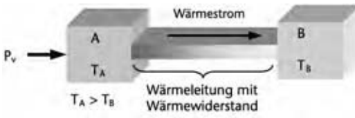
Abb. 300: Zur Erläuterung des Wärmewiderstandes R_{th}
