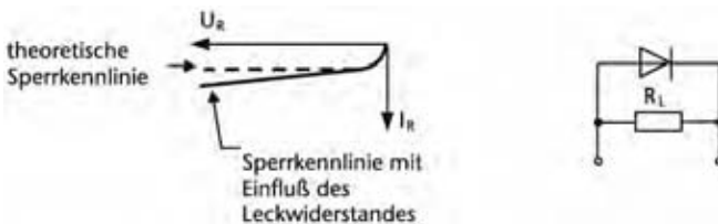
Abb. 291: Einfluß des Leckwiderstandes auf die Sperrkennlinie (links) und Ersatzschaltbild einer Diode mit Leckwiderstand (rechts)
