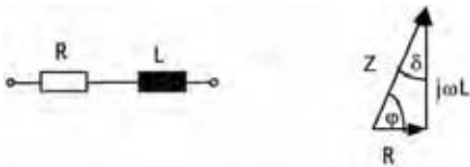
Abb. 203: Ersatzschaltung einer Spule mit Wicklungswiderstand R und zugehöriges Widerstandsdreieck
