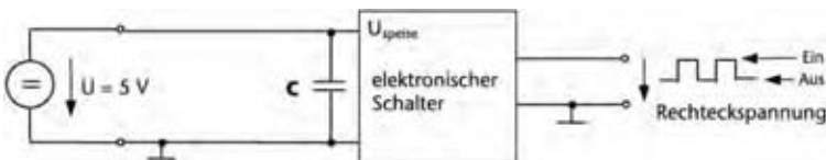
Abb. 66: Elektronischer Schalter für Spannung (ein / aus) mit Spannungsversorgung und Abblockkondensator »C«
