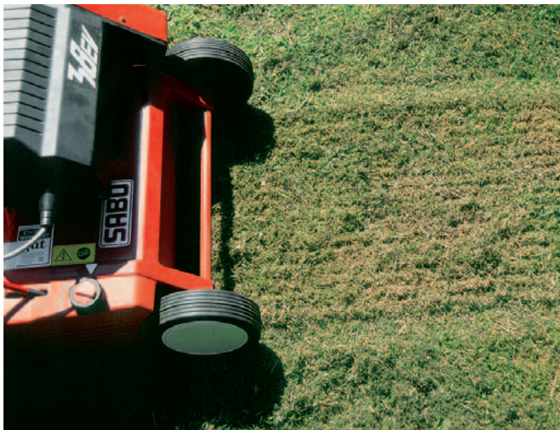
Das motorbetriebene Vertikutiergerät empfiehlt sich bei großen Flächen.
