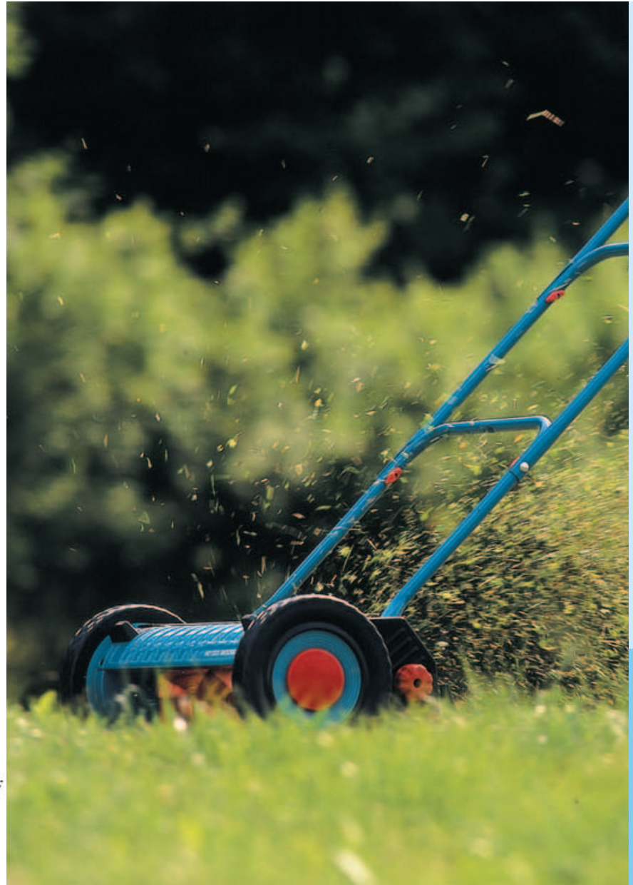
Ein Spindelmäher ergibt eine bessere Schnittqualität, doch das Mähen ist mit handgetriebenen Geräten anstrengender.
