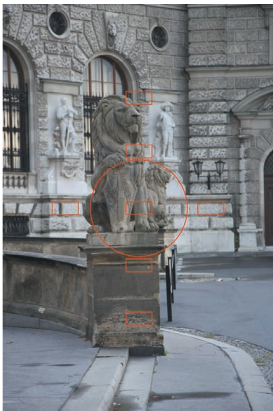
Bild 3.20: Im Sucher bzw. auf dem Display werden die Autofokussmessfelder von digitalen Kameras durch Markierungen (hier rechteckig) dargestellt. Über eine Taste am Gehäuse lassen sich die Messfelder einzeln anwählen bzw. bei manchen Modellen auch bewegen, um auch auf Motive außerhalb der Mitte scharf zu stellen.
