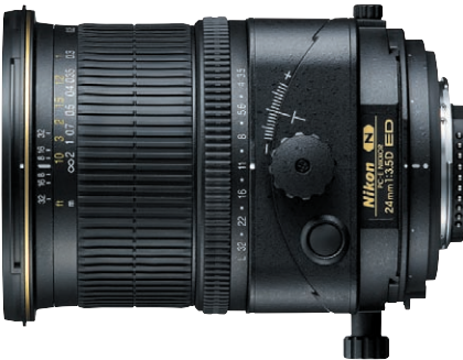
Bild 2.8: Seitenansichten des PC-E NIKKOR 24 mm 1.3, 5D ED. Das Objektiv eignet sich hauptsächlich zur Verwendung in der Architektur- und Landschaftsfotografie und für Objektaufnahmen insbesondere im Nahbereich. Durch die Verstellmöglichkeiten kann neben der Perspektive auch die Schärfentiefe beeinflusst werden.
