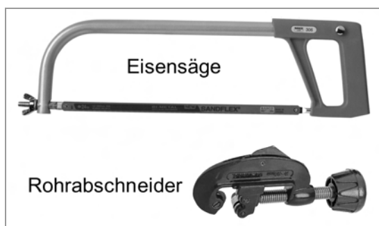
5) Eisensäge oder Rohrabschneider
