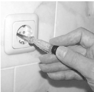
Abb. 1: Ein einfacher Neon-Phasenprüfer, der meistens in Form eines kleinen Schraubenziehers erhältlich ist, zeigt mit seinem Glühlämpchen das „Vorhandensein“ der Netzspannungsphase an.
