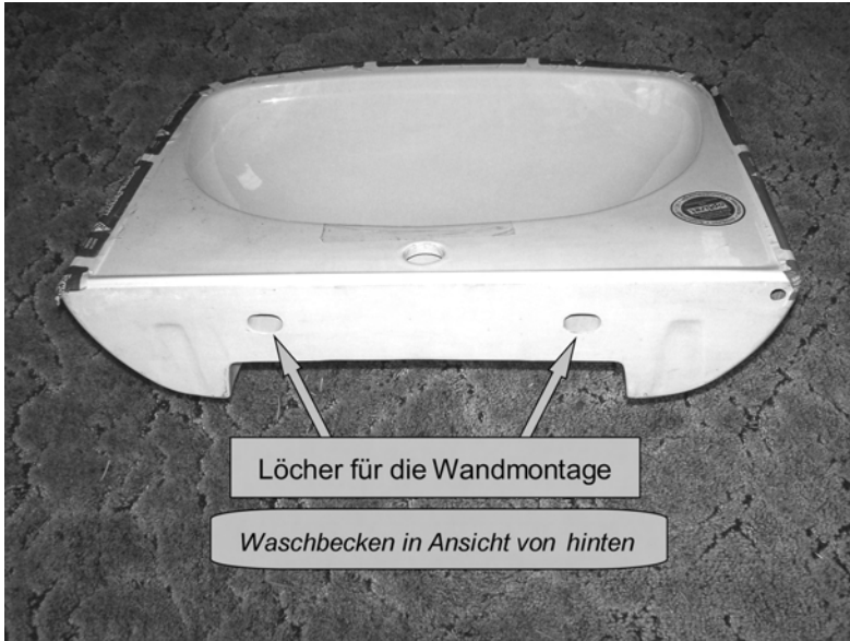
Abb. 91: Kleinere Porzellan-Waschbecken haben meist nur zwei Befestigungs-Löcher (größere Waschbecken bzw. Waschtische haben meist drei Befestigungslöcher). Porzellan-Waschbecken sind schwer und werden bevorzugt mit M8- bis M12-Stockschrauben in Kunststoffdübeln an der Wand befestigt (für kleinere Porzellan-Waschbecken genügen M8-Stockschrauben, für große Porzellan-Waschtische sind M12-Stockschrauben angesagt).
