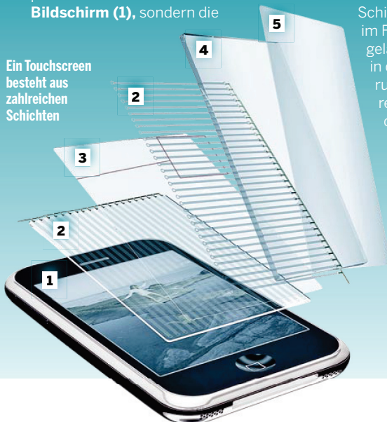
Der Finger verändert die elektrische Ladung im Gerät
