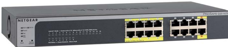
Der ProSAFE GS516TP kann Access Points, VoIP-Telefone oder IP-Kameras mit Strom versorgen, aber auch selbst ohne Netzkabel arbeiten
