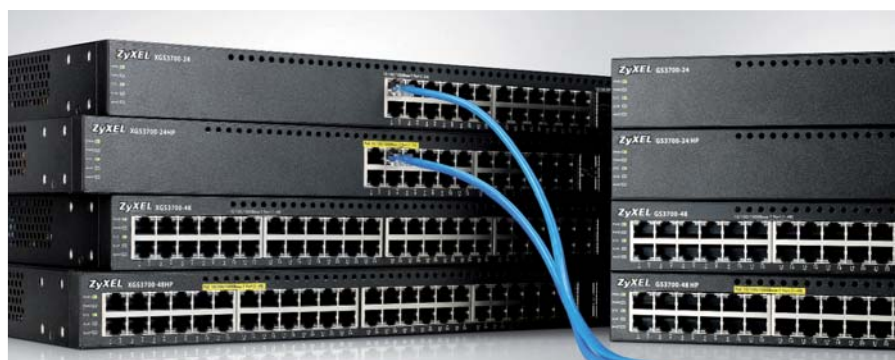
Die Modelle der XGS3700/GS3700-Serie bieten ein PoE-Budget bis zu 1.000 Watt bei zwei Stromversorgungen beziehungsweise 460 Watt bei einer Stromversorgung
